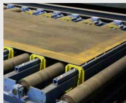
Système d'alignement automatique intégré à l'intérieur du chemin de roulement pour un changement rapide et facile par pont roulant.
