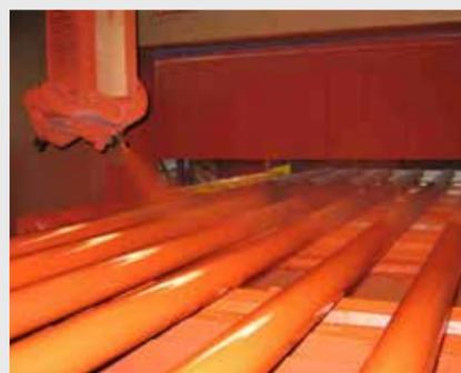
Dépose de peinture simultanée sur la face inférieure et supérieure du matériau pour obtenir une mise en peinture en un seul passage.
