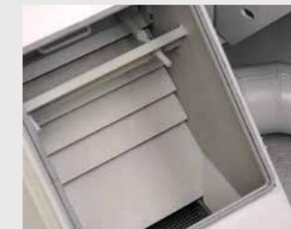
Nettoyeur d'air à cascade multiple pour une séparation idéale de la poussière et de la calamine des forges de la grenaillage. Ainsi on obtient une grenaillage propre et à nouveau réutilisable tout en minimisant l'usure de la machine.
