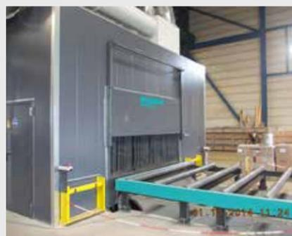
Un portillon coulissant réglable en hauteur côté entrée et sortie de la machine permet l'exploitation de matériaux de différentes hauteurs.
