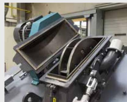
Turbines à double flasques avec 8 palettes d'accessibilité facile, très puissantes, entraînées par courroie.
