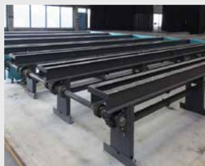
Les transporteurs transversaux jusqu'à 20 m de longueur pour un chargement et déchargement faciles. Système de transport de levage équipé de chariot lift et groupe hydraulique par traverse et une hauteur de levage de 120 mm.
