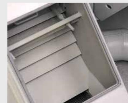
Nettoyeur d'air à cascade multiple pour une séparation idéale de la poussière et de la calamine des forges de la grenaille. Ainsi on obtient une grenaille propre et à nouveau réutilisable tout en minimisant l'usure de la machine.
