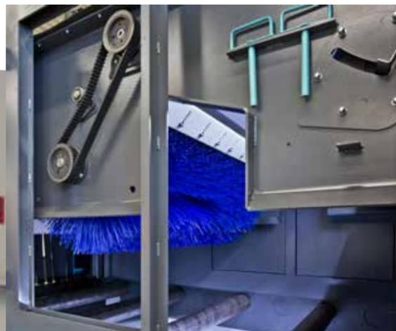
Plaques d'isolation phonique facilement démontables afin de réduire le niveau sonore jusqu'à 85 dBA. Grâce au design modulaire de cette machine, les plaques d'isolation phoniques sont des pièces - machine optionnellement intégrées, économisant de façon compacte la place et en apportant une solution d'entretien convivial (pas pour la SPRINT 3008).
