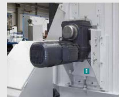
Élévateur à godets d'un support inférieur déplaçable facilement pour tendre la bande de l'élévateur à godets. En raison du support inférieur, la tension de la bande de l'élévateur à godets est le travail d'une seule personne étant donné qu'une seule vis est à régler (1).
