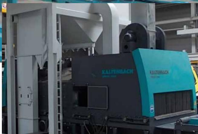
Pour nettoyer des petits matériaux tels que des pièces oxycoupées ou des tubes, l'installation de grenailage peut être étendue en soufflante haute-pression. Pour atteindre un degré de nettoyage optimal, elle est réglable en hauteur par rapport au matériau.
