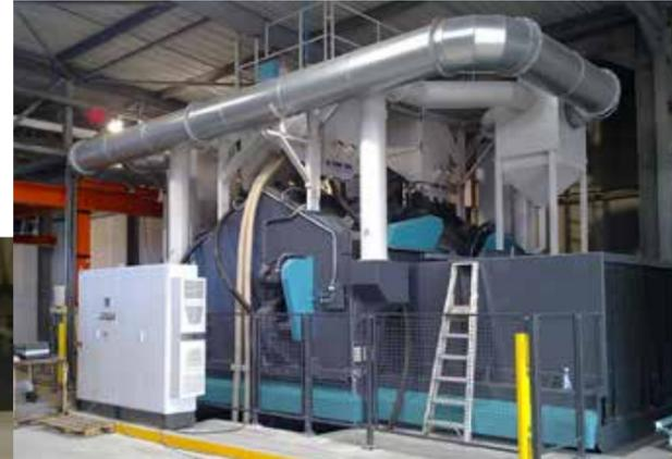
Le système de brossage/soufflage automatique est positionné derrière la chambre de grenailage pour enlever la grenaille des tôles et des profilés. Les réglages du cadre de la brosse par rapport au matériau sont réglables en pas de 5 mm et sont développés pour une exploitation durable sous haute exigence de production.
