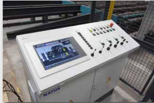
Pupitre de commande: installation de grenailage ainsi qu'installation de peinture peuvent être commandées à partir d'un pupitre.
