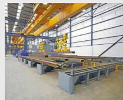
Plaques de protection spécifiques en bout des transports transversaux pour éviter des dommages dus aux camions et chariots élévateurs latéraux.
