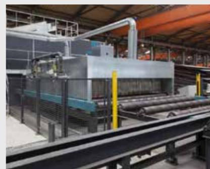
Le four de préchauffage économe en énergie et entièrement isolé garantit la bonne température du matériau avant la mise en peinture.
