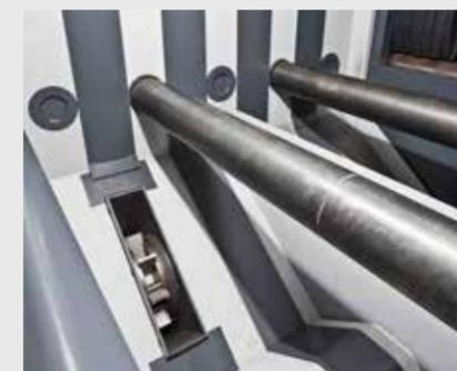
Rouleaux de transport trempés dans la cabine de grenailage. Les turbines sont placées de telle sorte qu'il ne peut y avoir aucune interaction entre elles.
