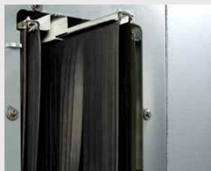
Changement facile par l'extérieur des rideaux en caoutchouc au niveau du sas d'entrée et de sortie (sauf pour SPRINT 3008).
