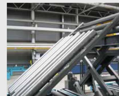
Dispositif d'inclinaison spécial afin d'enlever le reste de la grenaille des tubes grenailés.
