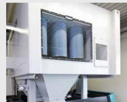
Installation de filtration intégrée pour un nettoyage de l'air optimum construite selon les dernières connaissances de la technique de séparation de la poussière.
