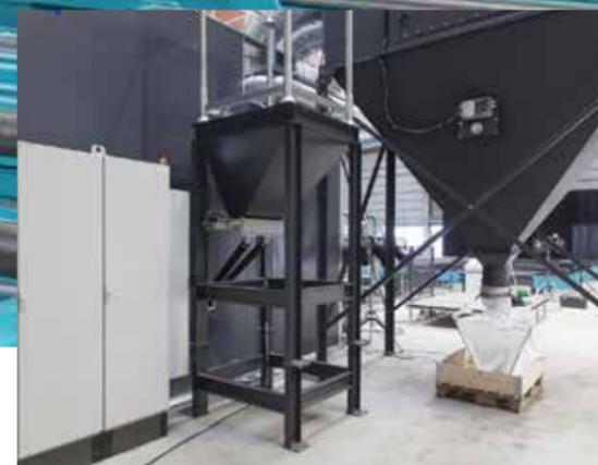
Afin de garantir une combinaison d'exploitation de la grenaille et d'un effet de nettoyage parfait, la grenailleuse doit être remplie régulièrement de nouvelles grenailles. Le système automatique de remplissage de KALTENBACH contrôle le niveau de remplissage du réservoir de grenaille de la machine et remplit ce dernier si nécessaire de grenaille complémentaire à partir d'un container séparé.
