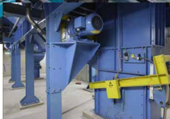
Comme l'entraînement de l'élévateur à godets doit être réajusté régulièrement, un appareil de serrage automatique sera proposé. Ainsi les coûts de maintenance sont réduits et un fonctionnement cohérent est garanti.
