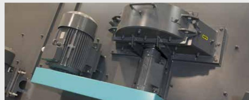
Turbines à double flasques avec 8 palettes d'accessibilité facile, très puissantes, entrainées indirectement par des courroies. KALTENBACH utilise un sous cadre pour le montage des turbines afin d'obtenir une meilleure stabilité de la machine et de ce fait, réduire les vibrations et les effets sonores. Les turbines à haute performance KALTENBACH sont équilibrées statiquement et dynamiquement.
