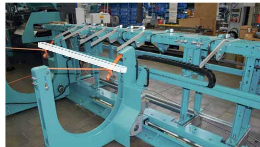
Convoyeurs robustes pour le transport des profilés et des tôles.
