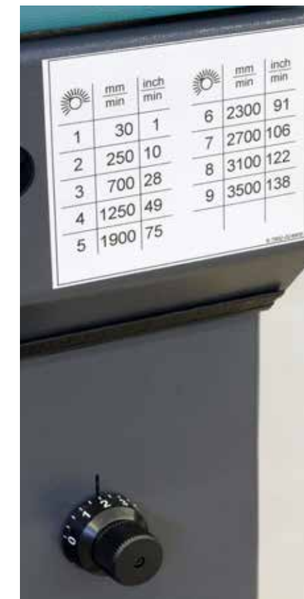
Régulateur d'avance pour un réglage universel en continu même pendant l'opération de coupe.
