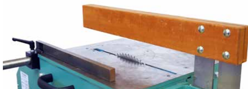
Dispositif de coupe longitudinale (pour TL 250 et TL 350) Avec butée réglable sur le guide circulaire.
