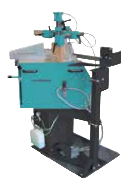
Socle de machine (pour TL 250 et TL 350) Socle de machine avec tourillon et plateau rotatif sur roulement à billes pour le pivotement de la machine en cas de coupes biaises. Flèche sur la butée de la pièce avec support pour conserver la direction d'amenée de la matière.
