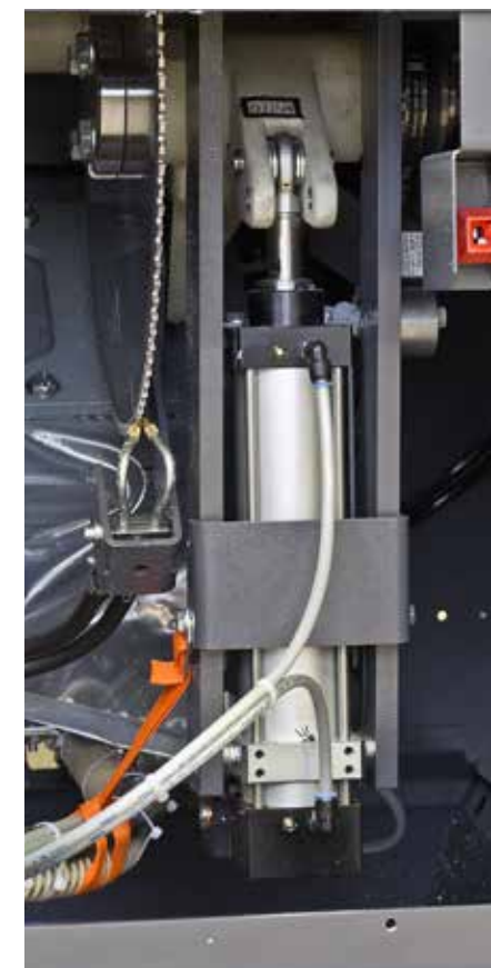
Avance de lame hydropneumatique.
