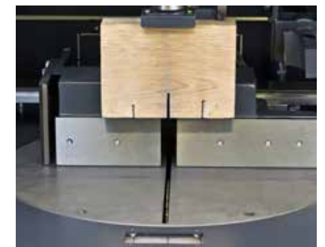
Élément de pression en bois dur vertical pour la protection de la surface de matière.
