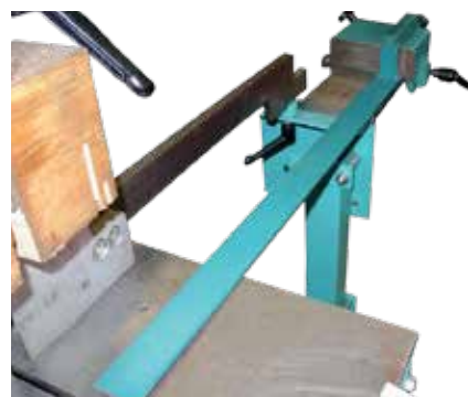
Longueur de butée L12 Y compris le support. Rail de guidage avec échelle de précision. Lecture de longueurs pour des coupes de 90° et 45°. Languette de butée pour sections courtes.
