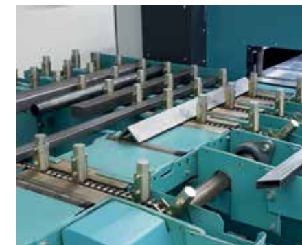
Magasin plat FM 1 (pour SKL 450 NA) Pour le pré-stockage de matières rondes et rectangulaires ainsi que de profilés (profilés spéciaux également).
