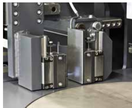
Positionnement ultra-précis de la matière par pince d'avance-barre à vis à billes.
