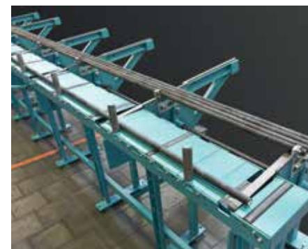
Magasin de chargement LM 1 (pour SKL 450 NA) Pour le pré-stockage de matières rondes et rectangulaires.
