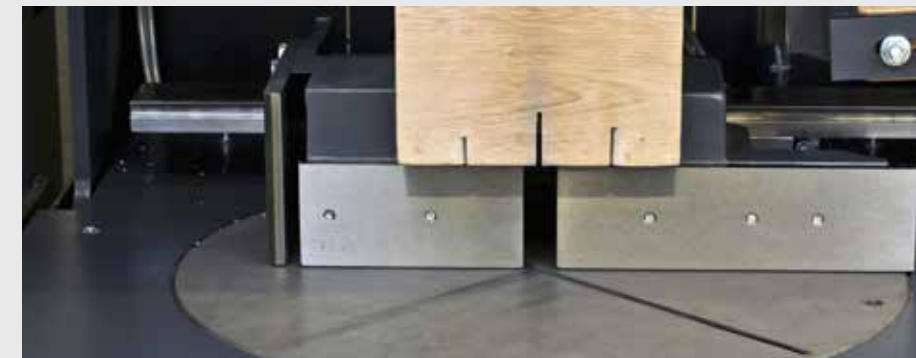
Plateau tournant pour les coupes biaisées avec angle de pivotement de 180°C.
