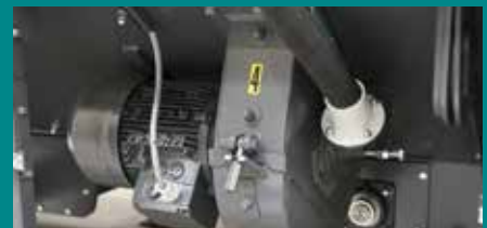
Direkte Doppelaufwerk-Scheibenturbinen mit 8 Scheiben.
