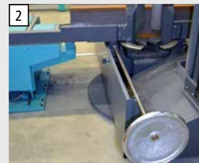
2 Гидравлически управляемые валики подачи для удаления коротких обрезков.
