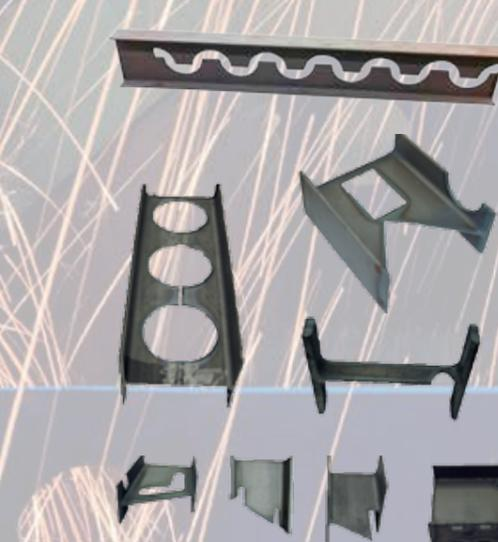
Возможность снимать фаски, вырезать внутренние контуры, вытянутые отверстия, стандартные отверстия, прямые и косые резы и резы со смещением.
