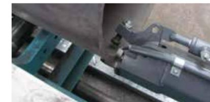
Измерительная каретка с грейферным захватом для обработки труб.
