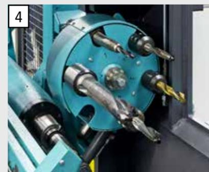
4 Автоматическая система смены инструмента, на каждой оси размещается по 6 инструментов.
