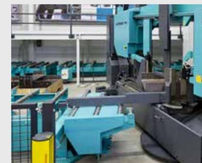
Подвижный приводной ролик позволяет отводить в автоматическом режиме короткие заготовки с косым резом.
