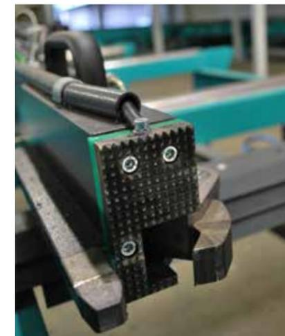
Измерительная каретка с грейферным захватом гарантирует надежный захват материала.
