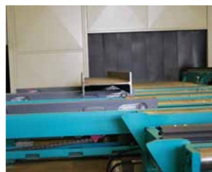
Поперечная транспортировка посредством подъемных кареток подходит для профилей в пачках и в пакетах, и для листового металла.
