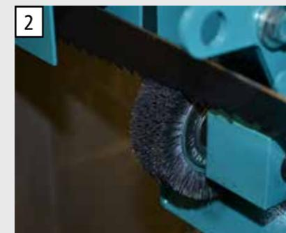
2 Щетка с отдельным приводом для удаления стружки с полотна пилы перед его входом в металл для высокого качества распила и длительного срока службы полотна.
