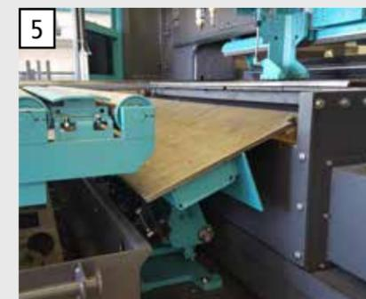
5 Быстрый автоматический сброс коротких готовых деталей для повышения автоматизации процесса и удобной разгрузки станка.
