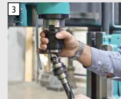
3 Простая ручная замена инструмента благодаря быстрому патрону с креплением для инструмента.
