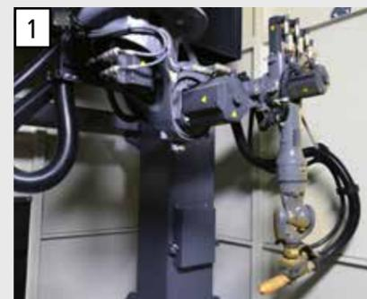
1 Движения робота выполняются посредством высокомоментных сервоприводов, обеспечивая максимальную точность при позиционировании.
