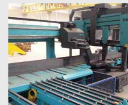
4 Полностью автоматизированная сортировка коротких деталей по заранее заданным позициям посредством устройства автоматической сортировки.
