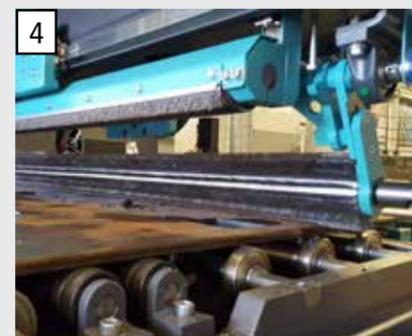
4 Безупречное удаление металлической стружки в автоматическом режиме с помощью вращающейся щетки продлевает срок службы расходных инструментов.
