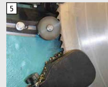
5 Устройство удаления металлической стружки с диска пилы для идеального качества распила.
