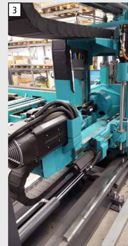
3 Сверлильный узел с мощным приводом перемещается с прижимом, что обеспечивает повышенную жесткость и стабильность.
