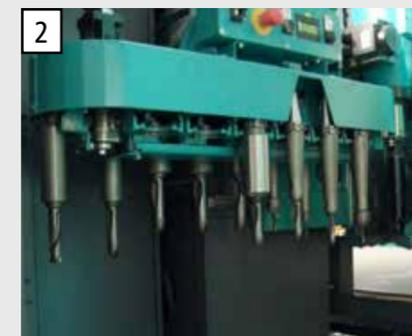
2 Устройство для смены инструмента на 14 инструментов а каждом блоке сокращает время на переоснащение.
