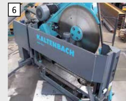
6 Установка угла реза на основе ЧПУ для максимальной точности.
