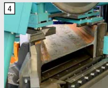
4 Автоматическое измерение сечения профиля при зажиме обеспечивает высокую надежность технологического процесса.
