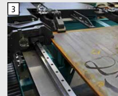
3 Две измерительные каретки автоматически измеряют и точно позиционируют материал, обеспечивая надежную фиксацию с помощью бокового рейферного захвата, который перемещается вдоль портала станка.
