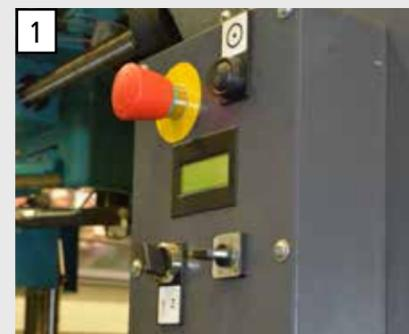
1 Отдельный блок управления устройством для смены инструмента для простой и безопасной замены.
