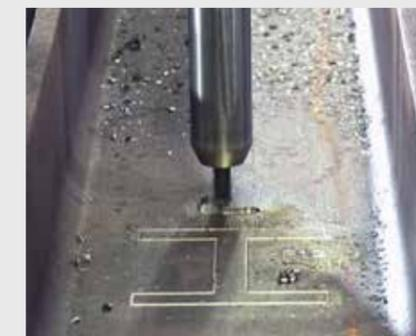
Высокоскоростное фрезерование осуществляется через удобную систему макросов с использованием инструментов KALTENBACH.
