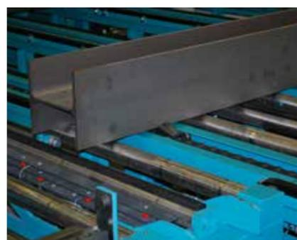
Поперечная транспортировка посредством цепного транспортера не требует частого обслуживания.
