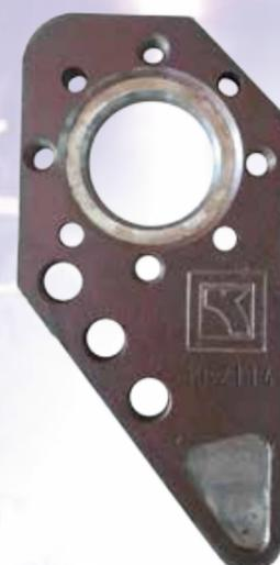
Сверление, зенкование, фрезерование, нарезание резьбы, контурная маркировка, маркировка прессом и термическая резка на одном станке.
