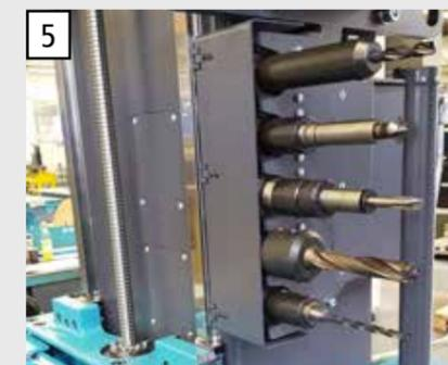
5 Автоматическая надежная и не требующая частого обслуживания система смены инструмента, на каждой оси размещается по 5 инструментов.
