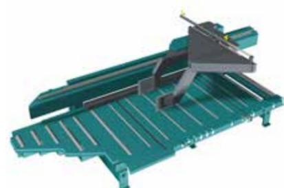
Автоматическая сортировка готовых деталей по заданным позициям. До 6 позиций для отвода.
