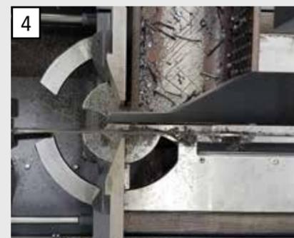
4 Рез под углом, не требующий юстировки по длине, обеспечивает высокое качество распила.
