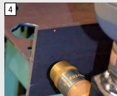
4 Лазерный датчик расстояния для бесконтактного измерения материала.
