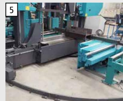
5 ЧПУ настройка угла распила на направляющей позволяет выполнятьрезы под углом на крупногабаритных профилях.
