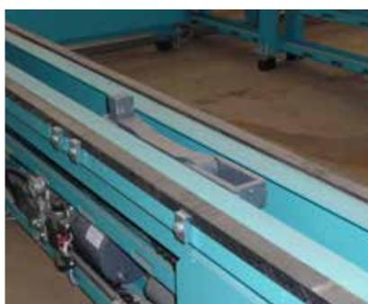
Поперечная транспортировка посредством транспортировочных штифтов для перемещения материала в двух направлениях.
