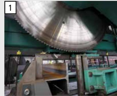
L'état de serrage hydraulique réduit les vibrations et augmente ainsi la durée de vie de la lame et la qualité de coupe.
