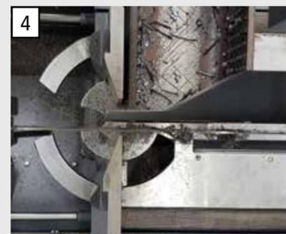
4 Coupes biaisées ne nécessitant aucune correction de longueur et permettant la plus haute qualité de coupe.
