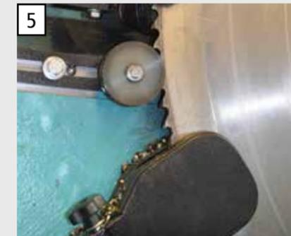
Élimination de copeaux dans les dents de la lame pour un résultat de coupe idéal et réduire les temps de coupe.
