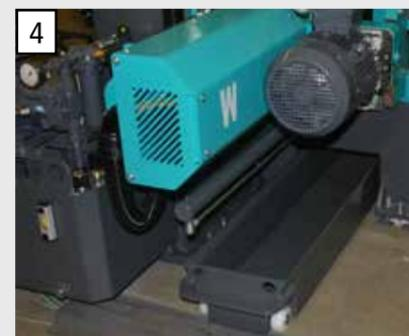
4 Manutention confortable des copeaux par convoyeur à copeaux ou bac à copeaux.
