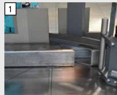
1 Réglage de l'angle de coupe à commande numérique. Système de serrage puissant et sûr pour une bonne qualité de coupe et une plus longue durée de vie des rubans.
