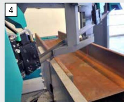
4 Laser pour coupe au tracé pour un alignement sûr et aisé de la matière pour les coupes en manuel.
