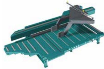
Évacuation automatique des bonnes pièces jusqu'à 6 positions d'évacuation.
