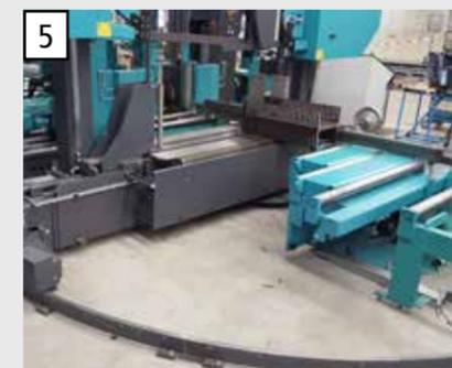
5 Réglage de l'angle de coupe par commande numérique sur rails de guidage permettant les coupes biaisées pour les gros profilés de charpente métallique.
