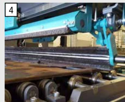
4 Élimination automatique et fiable des copeaux à l'aide d'une brosse à copeaux avant le processus de découpe pour assurer le bon déroulement et réduire les risques d'usure.
