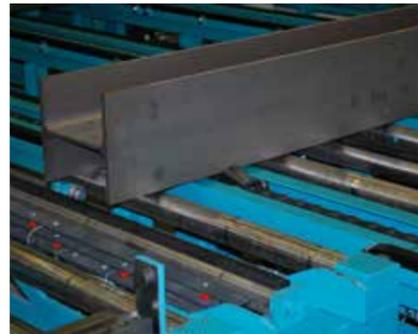
Conveyeur transversal à chaîne avec sabot robuste et faible en maintenance.
