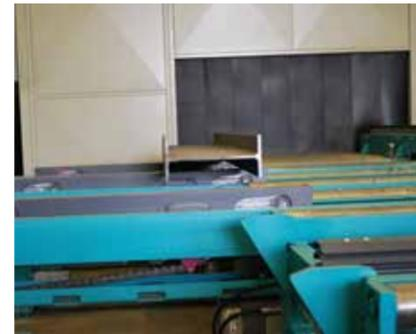
Conveyeur transversal par lift pour les nappes, les paquets et les tôles.
