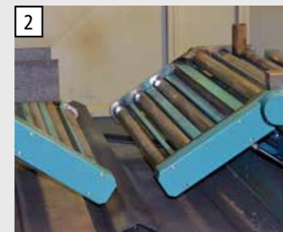
2 Segments de chemin de roulement rabattables hydrauliquement permettant une évacuation rapide des chutes et le transport des petites pièces.
