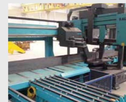
Manipulation entièrement automatisée des bonnes petites pièces sur des positions d'évacuation grâce à l'autosorter.
