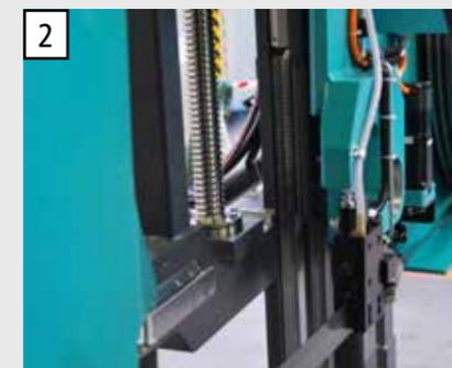
2 Vitesse d'avance de la scie par vis à bille et servomoteur pour une vitesse d'avance constante et indépendante de la température.
