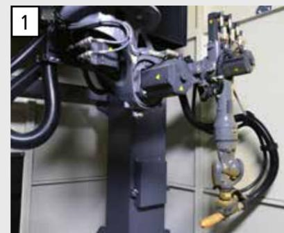
1 Les mouvements du robot s'effectuent grâce à des servo-moteurs puissants pour une haute précision de positionnement.
