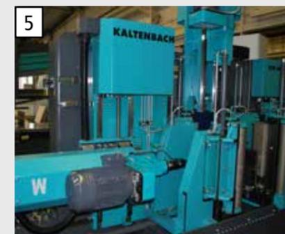
5 Positionnement précis et avance par servomoteur et vis à bille.
