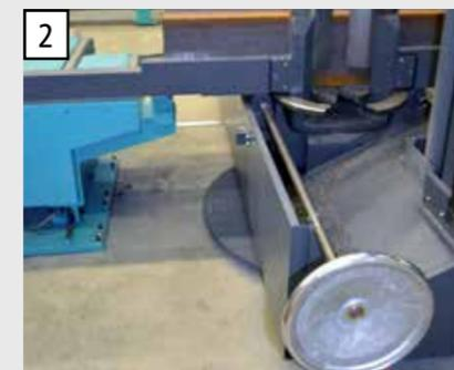
2 Rouleaux d'avance à montée hydraulique pour l'évacuation de petites chutes.
