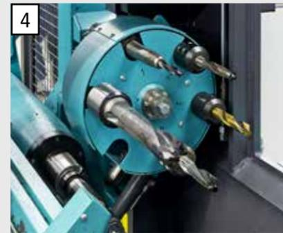
4 Changement automatique de six outils par axe de perçage grâce au magasin type barillet, directement placé à côté de l'axe de perçage afin de réduire les temps de changement.
