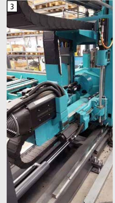
3 Axe de travail avec entraînement puissant, se déplaçant directement avec l'unité de serrage pour une rigidité et stabilité maximales.
