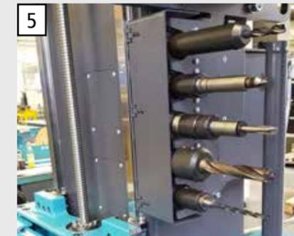
5 Magasin de 5 outils par axe de perçage automatique, fiable et à faible entretien.
