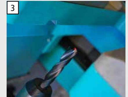
3 Mesure de longueur de l'outil par laser auto-nettoyant afin de minimiser la maintenance, d'assurer un haut processus et un temps faible de non-productivité.
