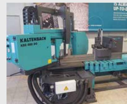
Scie automatique de paquet et de nappe grâce au NA (avance-barre) pour une plus grande efficacité de production.
