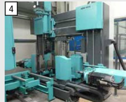
4 Construction robuste de la machine pour une durée de vie plus longue ainsi que des coûts faibles d'entretien et d'outillage grâce à une conception de machine à faibles vibrations.
