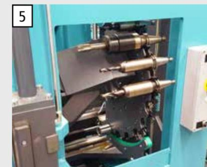
Grand changeur d'outil avec 12 emplacements par axe de perçage pour des temps de préparation et de changement courts et une grande variété d'outils.
