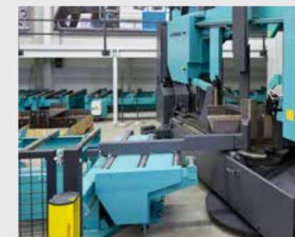
Convoyeur à rouleaux escamotable permettant les coupes biaisées avec évacuation automatique des pièces courtes.
