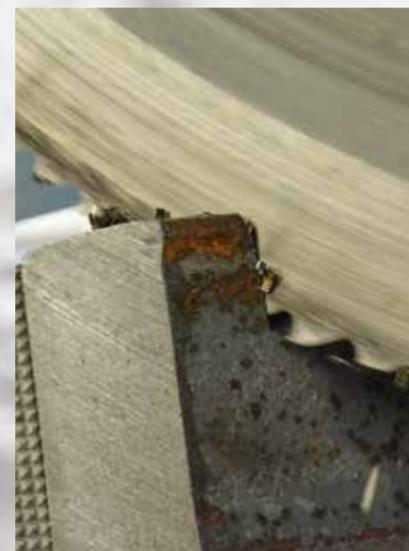
Pour les gros profilés de charpente métallique avec des cadences de coupe record. Coupe des pièces simples, en nappe ou en paquet.
