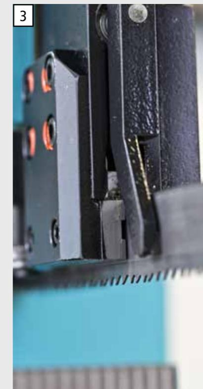
3 Des guides rubans à plaquettes carbure avec contrôle automatique de la pression assurent une coupe de grande précision.
