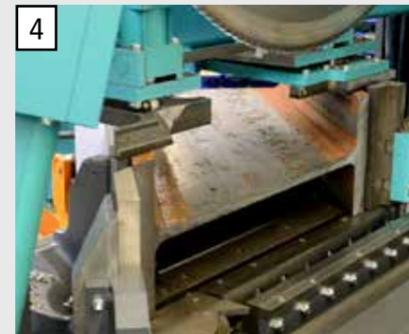
Mesure transversale automatique de la section à l'aide du serrage pour une grande fiabilité du processus.
