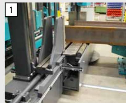
1 Double étai de serrage pour un maintien optimal de la matière pendant le cycle de sciage pour moins de vibration et une durée de vie du ruban plus longue.
