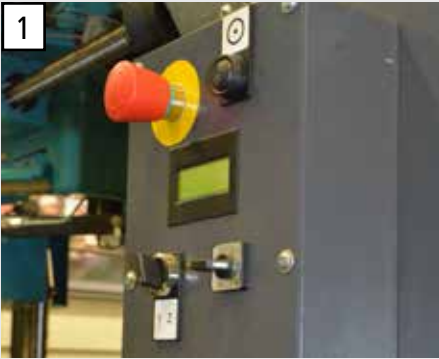
Werkzeugwechsler-Bedieneinheit zum einfachen und sicheren Wechseln der Werkzeuge.
