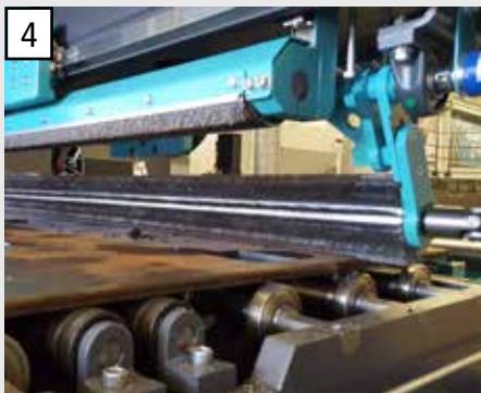
Automatische und zuverlässige Späne-Entsorgung mittels Spänebürste vor dem Brennprozess, um dessen Prozessablauf sicherzustellen und das Verschleißrisiko zu reduzieren.
