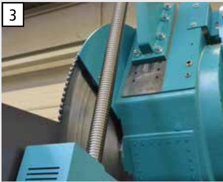
3 Temperaturunabhängiger Vorschub über Kugelrollspindel für ideale Schnittergebnisse und lange Sägeblattstandzeiten.
