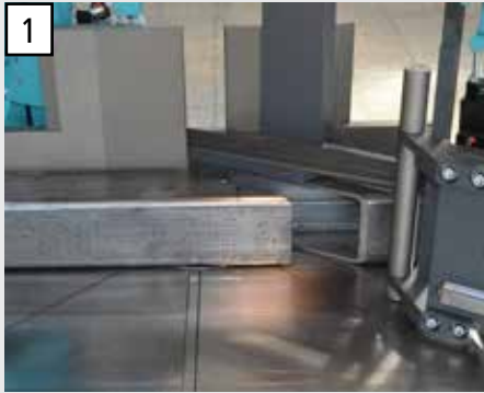
NC-gesteuerte Schnittwinkleinstellung. Kraftvolles und sicheres Spannsystem für gute Schnittqualität und lange Sägebandlebenszeit.
