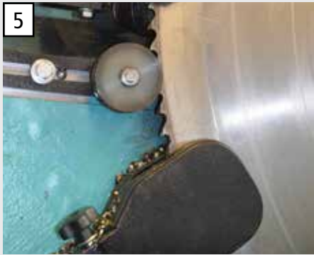
5 Späneräumer zur Reinigung des Sägeblattes für ideale Schnittergebnisse und niedrigere Schnittzeiten.
