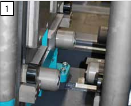
1 Stabiler, wartungsarmer Spannstock für optimale Materialspannung und längere Werkzeugstandzeiten.
