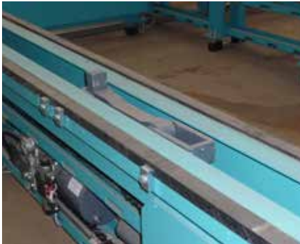
Quertransport mittels Hub-Pins für den schleppenden Materialtransport in zwei Richtungen.
