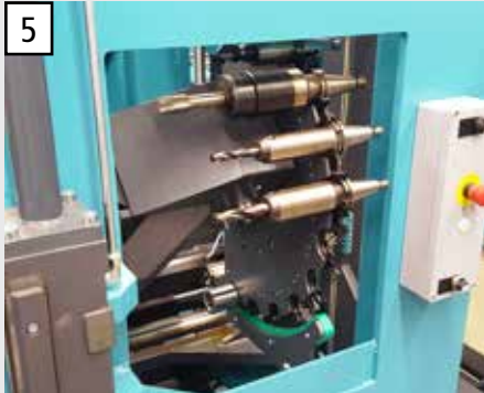
Großer Werkzeugwechsler mit 12 Werkzeugplätzen pro Bohrachse für kurze Rüst- und Wechselzeiten und bei hoher Werkzeugvielfalt.
