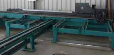
Messwagen mit Doppelgreifer für den Einsatz bei geringem Platzbedarf.
