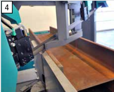
Laser zum Sägen auf Anriss für einfaches und sicheres Ausrichten des Materials bei manuellen Sägeschnitten.
