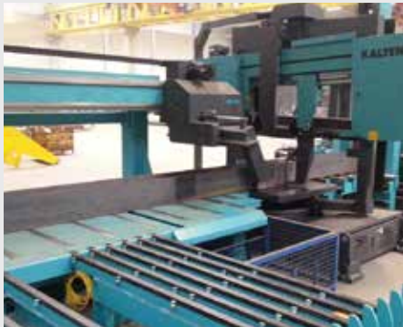
Vollautomatisiertes Handling von kleinen Gutteilen auf mehreren Abschiebepositionen durch den Autosorter.
