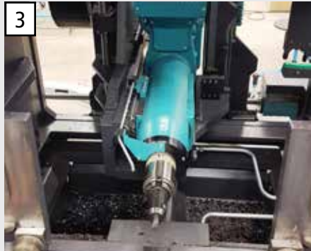
Zusätzliche Vorschub-Achse von 500 mm in Materialfluss-Richtung, so dass das Werkstück von allen drei Seiten gleichzeitig und unabhängig voneinander bearbeitet werden kann.
