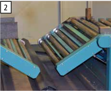
2 Hydraulisch klappbare Rollenbahnsegmente erlauben den einfachen Abtransport von Abschnitten und den Transport kleiner Teile.
