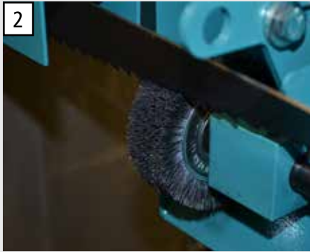
Separat angetriebene Spänebürste reinigt das Sägeband nach dem Eingriff und gewährleistet geringe Schnittzeiten und geringe Verunreinigungen.
