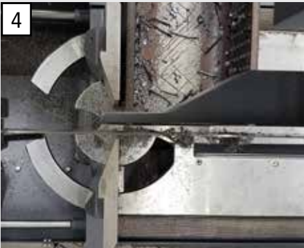
4 Längenkorrekturfreie Gehrungsschnitte ermöglichen höchste Schnittqualität.
