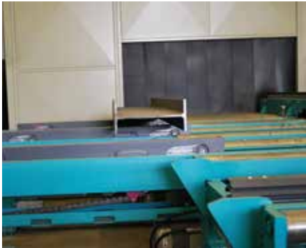
Quertransport mittels Hubwagen vor allem für Profil-Bündel, -Lagen und Bleche.
