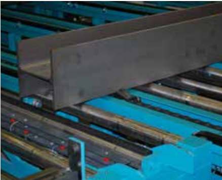
Quertransport mittels Schleppketten für robusten und wartungsarmen Transport.
