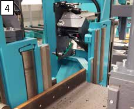
Kräftiges Spannsystem mit einer Kombination aus Rollen und Spannbacken zur Reduktion von Vibrationen und kürzeren Durchlaufzeiten.
