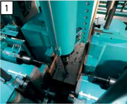
1 Rationelles Bohren, Contour Marking, Körnen, Senken und Gewindeschneiden auf allen drei Bohrachsen.
