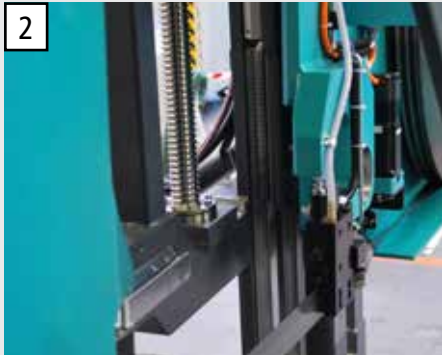
Sägevorschub mit Kugelrollspindel und Servomotor für konstanten und temperaturunabhängigen Vorschub.
