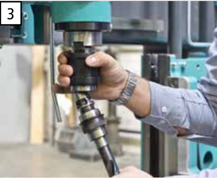
3 Einfacher manueller Werkzeugwechsel durch Schnellwechselfutter.
