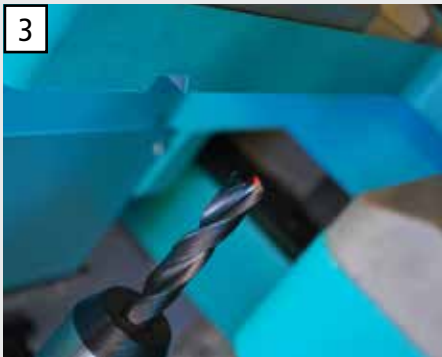
3 Werkzeuglängenvermessung mit selbstreinigender Laser-Lichtschranke für wartungsarmen Betrieb sowie hohe Prozesssicherheit und niedrige Nebenzeiten.
