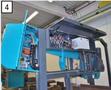
Alle Wartungskomponenten wurden konstruktiv zusammen gelegt und sind leicht erreichbar.
