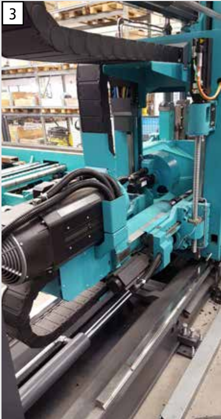
Bearbeitungsachse mit leistungsstarkem Antrieb verfährt direkt mit Spanneinheit für höhere Steifigkeit und Stabilität.
