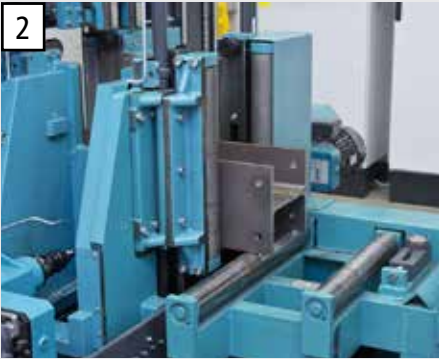
2 Intelligente Materialvermessung im Spannsystem integriert für höhere Prozesssicherheit.
