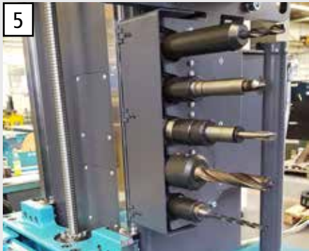
5 Automatischer, zuverlässiger und wartungsarmer Werkzeugwechsler für fünf Werkzeugplätze pro Bohrachse.
