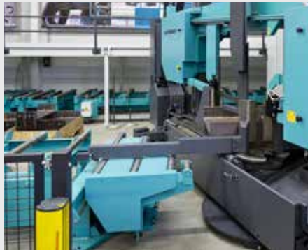
Verfahrbare Rollenbahn ermöglicht Gehrungsschnitte mit automatischem Abtransport von kurzen Teilen.
