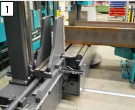
1 Doppelspannstock zur sicheren Fixierung des Materials während des Sägeprozesses für weniger Vibration und längere Sägebandstandzeiten.
