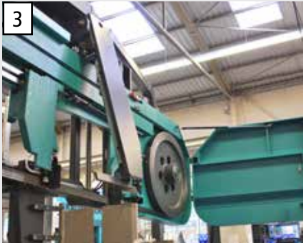
Bandwechselposition wird automatisch angefahren, um kürzeste Nebenzeiten zu erreichen.
