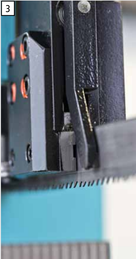
Hartmetallbestückte Sägebandführungen und automatische Vorschubregelung sorgen für höchste Schnittgenauigkeit.
