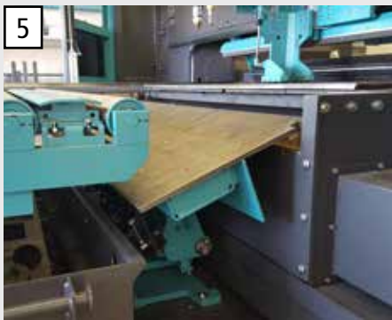
Schnelles und automatische Abkippen von Kleinteilen für eine höhere Automatisierung und Maschinenauslastung.
