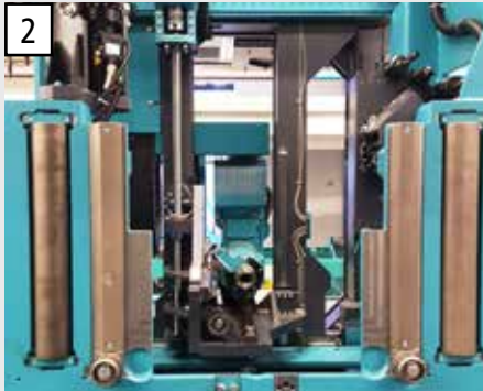
Direkte Aufhängung der Bohrachsen am Maschinenportal und Spannstock ermöglichen kurze Verfahrwege für kürzere Prozesszeiten und vibrationsarme Bearbeitung.
