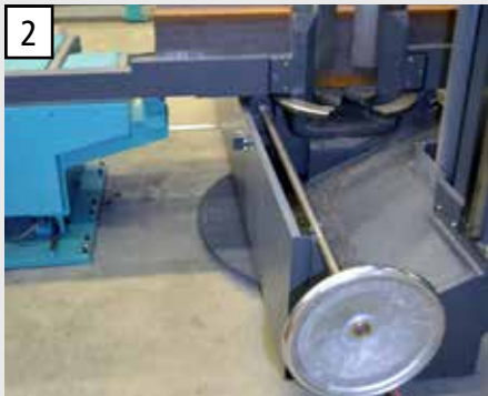
2 Hydraulisch anhebbare Nachschubwalzen zum Abtransportieren von kurzen Reststücken.
