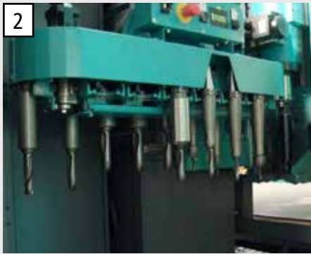
Geringere Rüstzeiten durch 14-fachen Werkzeugwechsler pro Bearbeitungsachse.
