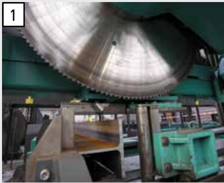
1 Starker hydraulischer Spannstock reduziert Vibrationen und erhöht damit die Sägeblattstandzeit und Schnittqualität.
