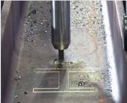
Fräsbearbeitungen sind durch Makros einfach implementierbar und vor allem mit KALTENBACH Power Tools leistungsstark durchführbar.
