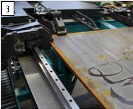
Zwei Messwagen vermessen Bleche automatisch und positionieren diese exakt. Materialfixierung durch seitlichen Greifer, welcher durch das Maschinenportal verfährt.
