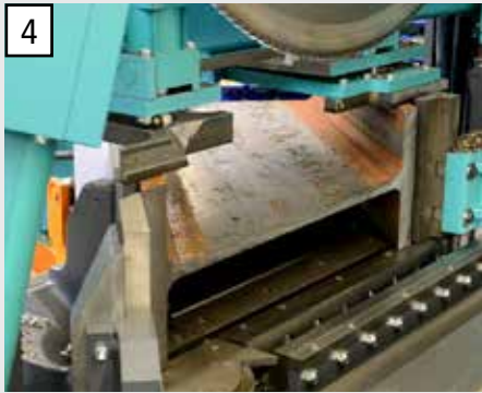
4 Automatische Querschnittsvermessung beim Spannen für eine hohe Prozesssicherheit.
