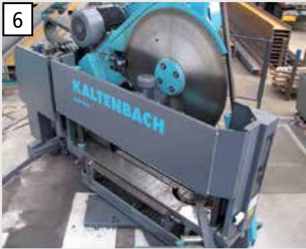
6 NC-gesteuerte Schnittwinkeleinstellung ermöglicht genaue Positionierung.
