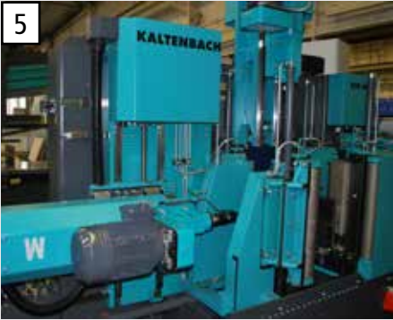
5 Servomotor und Kugelrollspindel für genaueste Bohrachsenpositionierung und Vorschubsteuerung.
