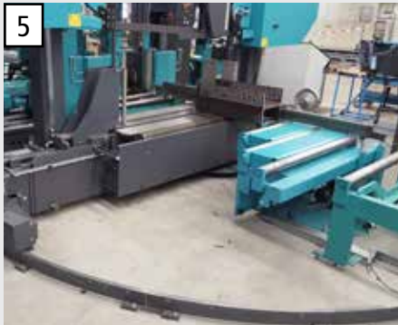
5 NC-gesteuerte Winklereinstellung auf Führungsschiene ermöglicht Gehrungsschnitte bei sehr großen Stahlprofilen.
