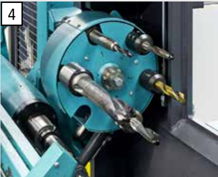
Automatischer, zuverlässiger und wartungsarmer Werkzeugwechsler für sechs Werkzeugplätze pro Bohrachse.
