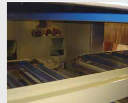
Точное распыление краски благодаря системе определения контуров материала и системе контроля направления распылительных форсунок.
