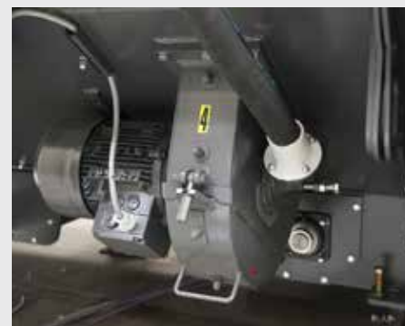
Двойные дисковые турбины с прямой передачей, по 8 лопаток.
