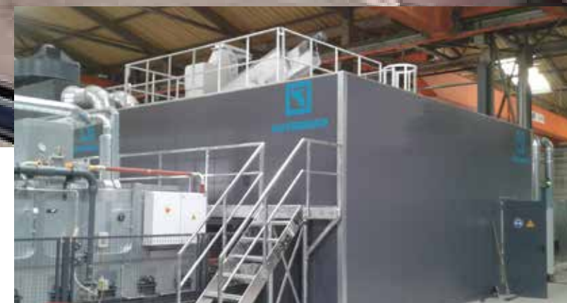
Специальный корпус дробеметной установки для снижения уровня шума.
