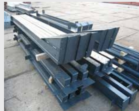
Окрашенные стальные конструкции.
