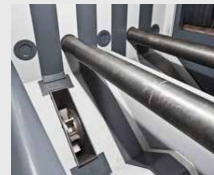
Транспортировочные ролики из каленой стали. Турбины расположены на разном уровне, для избегания столкновений.
