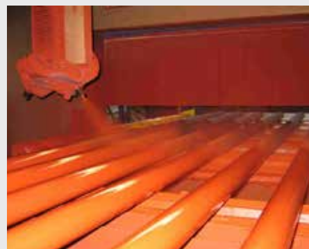
Одновременное распыление краски сверху и снизу позволяет окрасить материал за один прогон.
