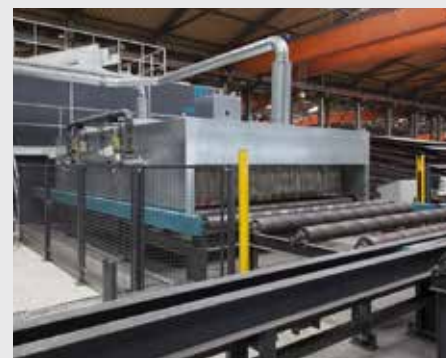
Энергосберегающие печи предварительного нагрева обеспечивают необходимую температуру материала перед окрашиванием.
