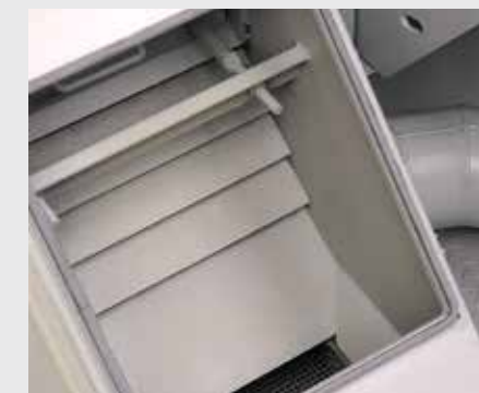
Оптимальный многоуровневый каскадный воздушный очиститель отделяет пыль и окалину из дробеструйного абразива.
