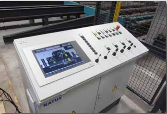
Пульт управления: дробеметная установка и покрасочная камера могут управляться с одного пульта управления
