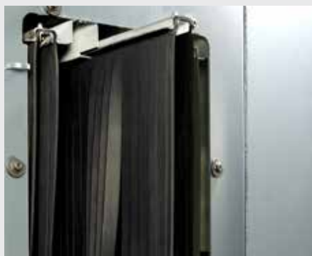
Легкая замена резиновых шторок шлюзовой камеры подачи и разгрузки (кроме SPRINT 3008).
