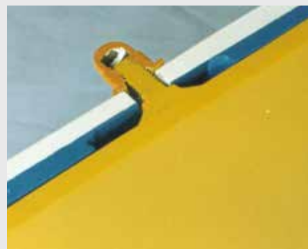
Тройной корпус дробеметной установки, толщиной 22 мм., стабильность, высокая прочность, быстрая замена благодаря конструкции, крепящейся на болтах.
