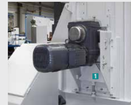
Becherwerk ausgestattet mit einem einfach verfahrenen Untergerüst, um das Becherwerkband zu spannen. Aufgrund des Untergerüsts ist das Spannen des Becherwerkbandes ein Ein-Mann-Job, da lediglich eine Schraube verstellt werden muss (1).
