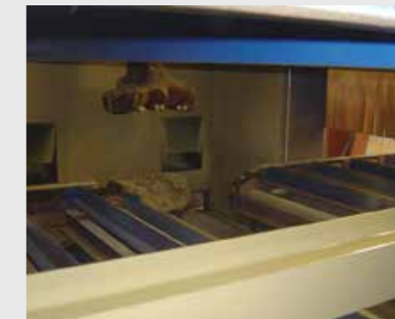
Reduzierter Farbnebel, durch präzise Konturbestimmung der zu beschichteten Oberflächen und durch exakte Kontrolle der Farbpistolen.
