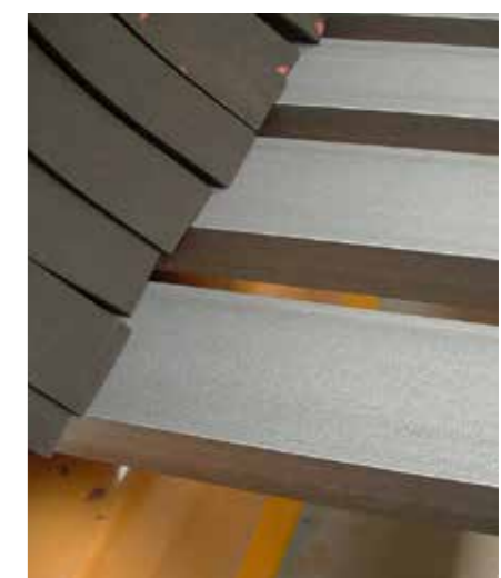
Mehrstufige Kaskaden-Luftreinigung für ideale Trennung von Staub und Walzzunder von dem Strahlmittel. Somit wird ein staubfreies, wiederverwendbares Strahlmittel erreicht und der Verschleiß der Maschine minimiert.
