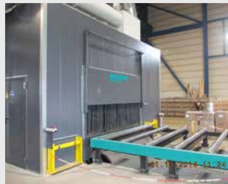
Ein höhenverstellbares Schiebetor an der Einfuhr- und Ausfahrseite der Maschine ermöglicht die Bearbeitung von unterschiedlichen Materialhöhen.
