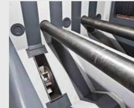
Gehärtete Transportrollen in der Strahlkammer. Die Turbinen sind versetzt angeordnet, damit keine gegenseitige Bestrahlung stattfindet.
