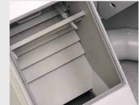
Mehrstufige Kaskaden-Luftreinigung für ideale Trennung von Staub und Walzzunder von dem Strahlmittel. Somit wird ein staubfreies, wiederverwendbares Strahlmittel erreicht und der Verschleiß der Maschine minimiert.
