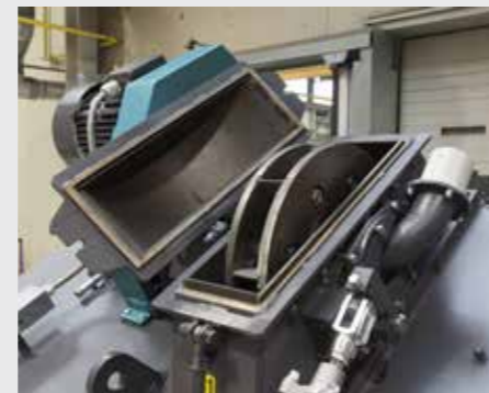
Leicht zugängliche, leistungsstarke, indirekt von Keilriemen angetriebene Doppelscheibenturbinen mit 8 Schaufeln.
