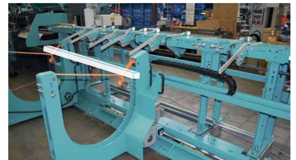
Robuster Förderer für höchste Standards im Transport von Stahlprofilen und -blechen.
