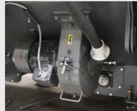
Direkt angetriebene Doppelscheibenturbinen mit 8 Schaufeln.
