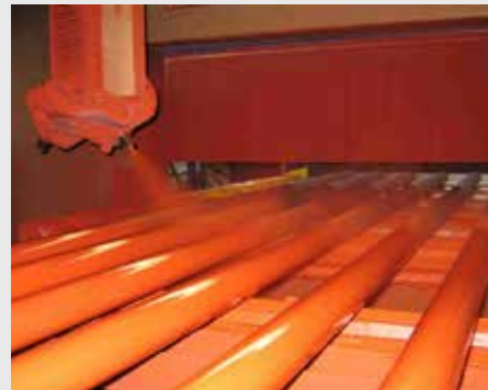
Gleichzeitige Farbauftragung an der Ober- und Unterseite des Materials, um komplette Lackierung in einem Durchgang zu erreichen.
