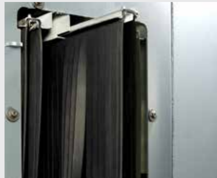
Einfaches Auswechseln der Gummivorhänge der Ein- und Auslaufschleuse von außen (außer SPRINT 3008).
