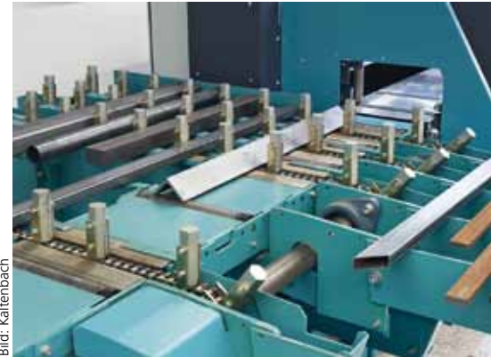
Bild 3: Das Flachmagazin zur Vorlagerung von Rund- und Vierkantmaterial sowie von Profilen und Sonderprofilen.
