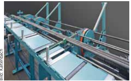
Bild 2: Das Bundmagazin eignet sich zur Vorlagerung von Rund- und Vierkantmaterial im Bund.
