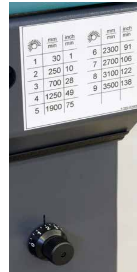
Регулятор для плавной настройки подачи диска пилы во время процесса пиления.
