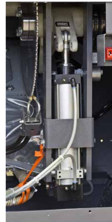
Гидропневматическая подача режущего диска.
