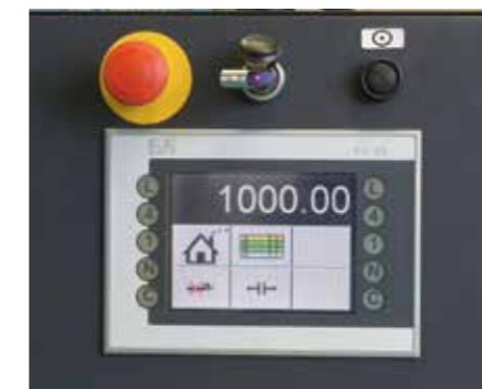
Устройство для измерения длины L 41 NC Установка длины измерительной системой с двигателем, ЧПУ управление. Упорный рукав после позиционирования зажимается автоматически. Простое управление с панели с сенсорным экраном.
