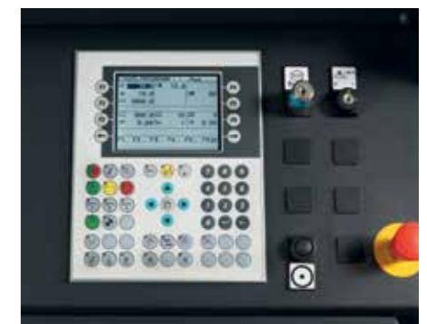
Простое ЧПУ-управление и программирование с панели ввода данных.
