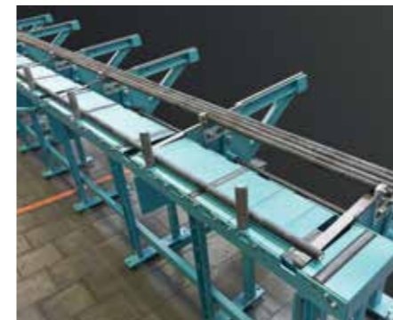
НАКЛОНЯЕМЫЙ НАКОПИТЕЛЬ LM 1 (для SKL 450 NA) Для загрузки материала круглого и квадратного сечения.
