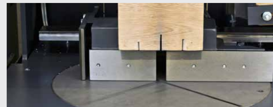
Поворотный стол для реза под углом. Угол поворота 180°.
