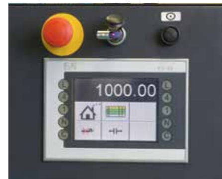
Устройство для измерения длины L 41 NC (для TL 450) Установка длины измерительной системой с двигателем, ЧПУ управление. Упорный рукав после позиционирования зажимается автоматически. Простое управление с панели с сенсорным экраном.
