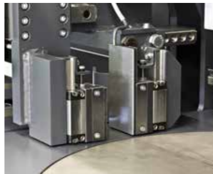
Высокоточное позиционирование материала с помощью грейферного захвата с шарико-винтовой парой.
