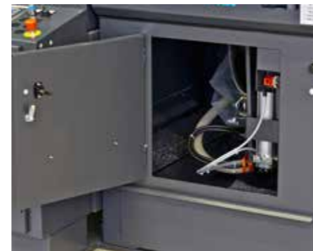
Большая боковая дверца для быстрой замены диска пилы и технического обслуживания.
