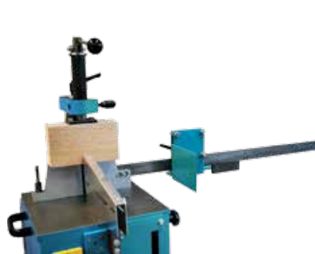
Längenanschlag L10 Arbeitsbereich 0 - 1000 mm.
