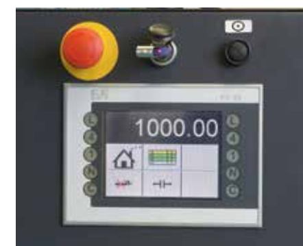
Längenmesseinrichtung L 41 NC Zur motorischen Einstellung der Messlänge über NC-Steuerung. Der Anschlagwagen wird nach dem Positionieren automatisch geklemmt. Einfache Bedienung über Touchscreen.
