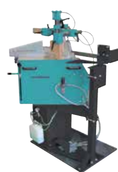
Maschinensockel (für TL 250 und TL 350) Maschinensockel mit Drehzapfen und kugellagerter Drehplatte zum Schwenken der Maschine bei Schrägschnitten. Ausleger am Werkstückanschlag mit Abstützung für die Beibehaltung der Materialzufuhrrihtung.
