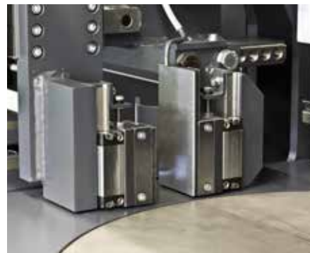
Hochpräzise Materialpositionierung mittels Nachschubgreifer mit Kugelrollspindel.
