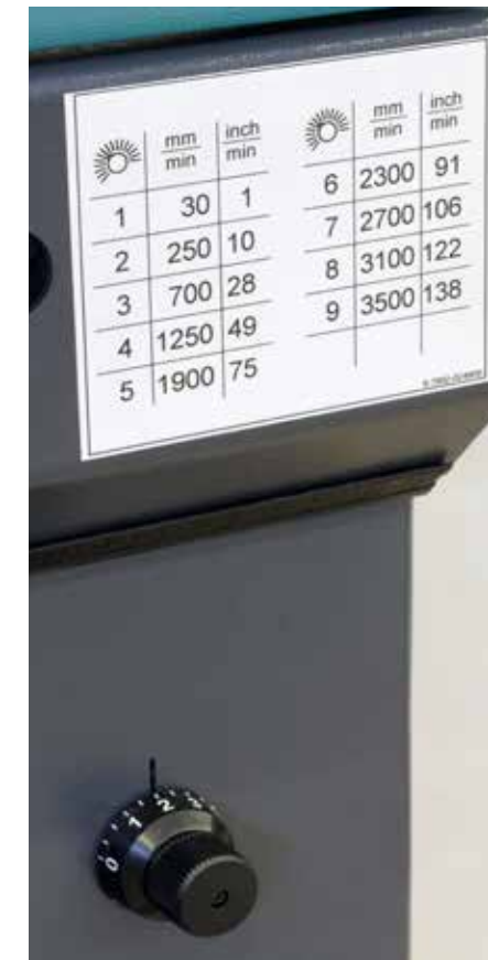
Vorschubregler für universelle, stufenlose Einstellung auch während des Sägeprozesses.
