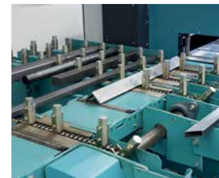
Flachmagazin FM 1 (für SKL 450 NA) Zur Vorlagerung von Rund- und Vierkantmaterial sowie von Profilen (auch Sonderprofile).
