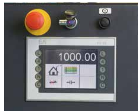
Längenmesseinrichtung L 41 NC (für TL 450) Zur motorischen Einstellung der Messlänge über NC-Steuerung. Der Anschlagwagen wird nach dem Positionieren automatisch geklemmt. Einfache Bedienung über Touchscreen.
