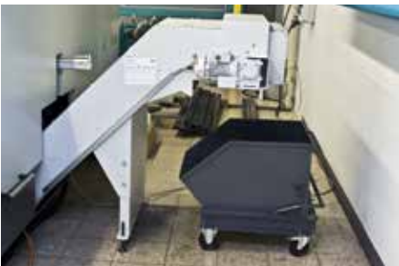
Шарнирно-ленточный транспортер для автоматического удаления стружки и обрезков
