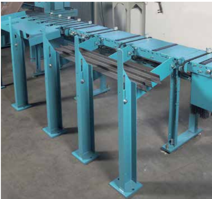
2 Устройство поперечной сортировки с опускаемым накопителем
