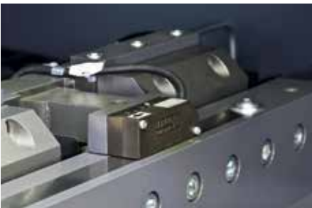
Измерение ширины материала с автоматической коррекцией длины для точного распила под углом
