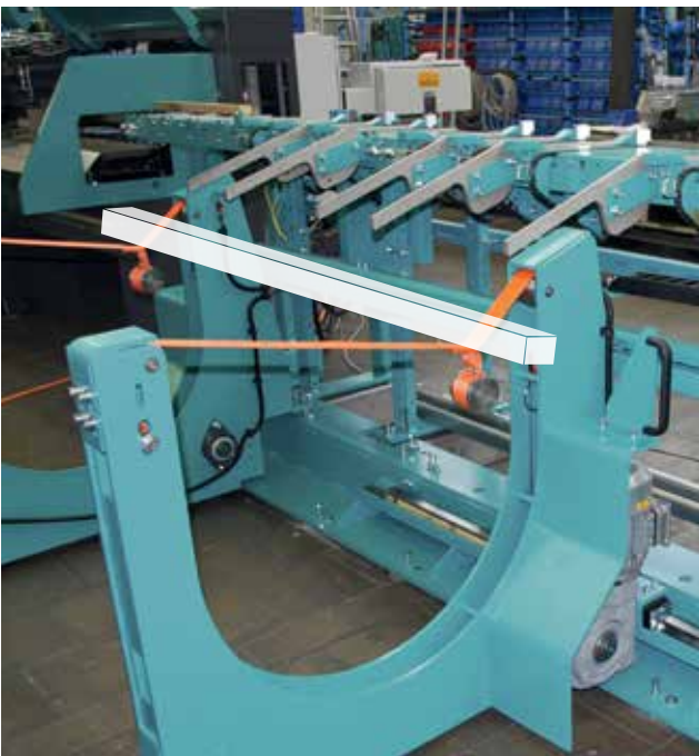
3 Автоматически опускающиеся ременные петли для распределения отрезков
