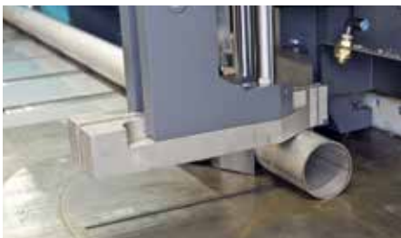
Автоматическое программируемое снижения давления на зажимах с помощью клапанов пропорционального регулирования для обработки тонкостенных труб и специальных профилей
