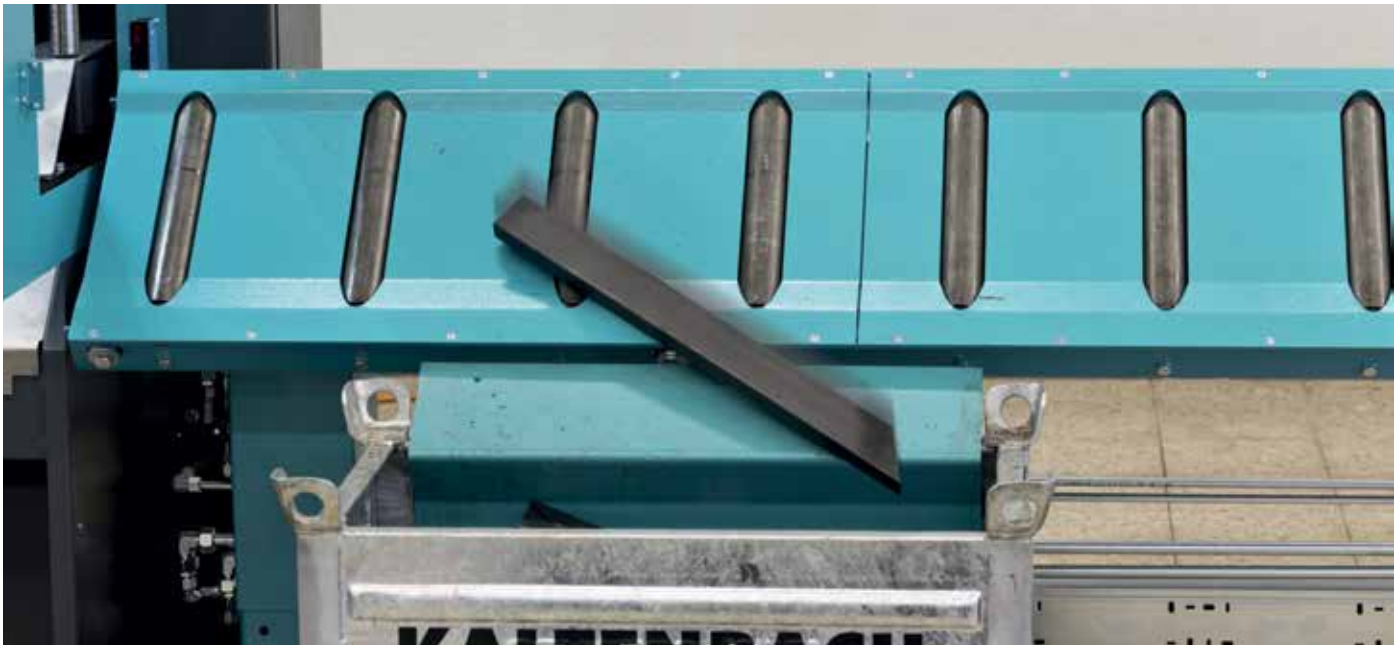
1 Опрокидывающийся рольганг Сбрасывающее устройство сортирует готовые отрезки в заранее подготовленные накопители
