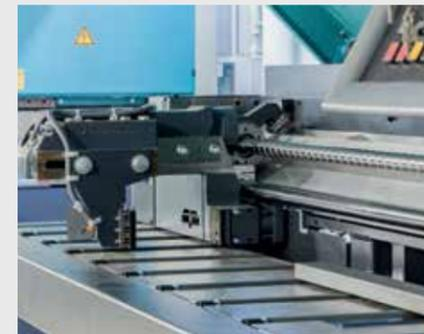
Positionnement hautement précis de la matière à scier par pince d'avance barre avec vis à bille et servomoteur sans brosse
