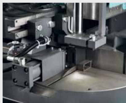
Butée déplaçable pour coupes 90° et des chutes courtes en mode automatique
