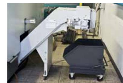
Evacuateur à bandes pour l'évacuation automatique des copeaux, affranchissements/chutes et fausses pièces
