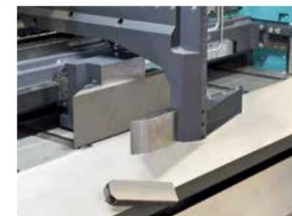
Pince d'évacuation pour le serrage des pièces du côté évacuation et pour le triage des affranchissements/ chutes et bonnes pièces dans des positions présélectionnées
