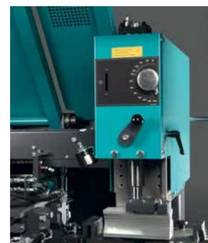
Avance hydraulique de la lame, avec réglage à variation continue
