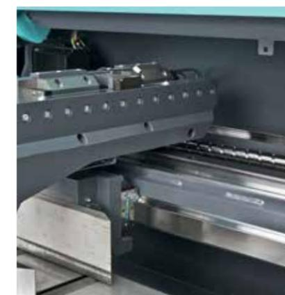
Positionnement très précis des pièces sciées par vis à billes avec servomoteurs sans brosse. Avance de la pince sur des guides linéaires robustes, sans entretien
