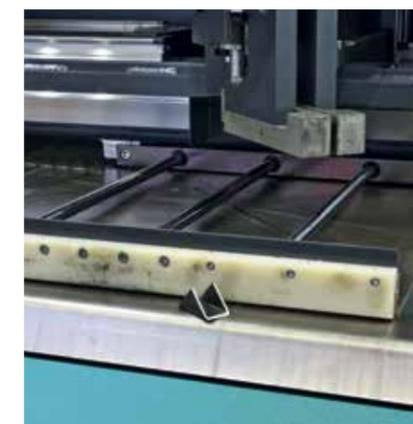
Système chasse-copeaux pour l'élimination des copeaux, affranchissements/chutes et fausses pièces
