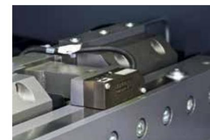
Mesure de la largeur des pièces correction automatique des longueurs pour coupes biaisées précises
