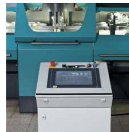
Pupitre de commande isolé pour un aménagement souple de la machine
