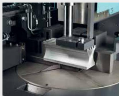
Serrage de la matière de part et d'autre de la scie. Butée pour coupes biaisées bilatérales
