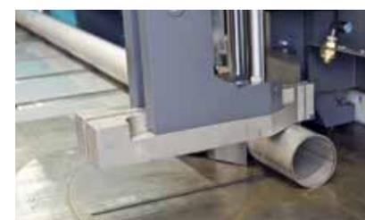
Réduction automatique de la pression de serrage, commandée par programme par vanne proportionnelle pour l'usinage de tubes minces et de profilés spéciaux
