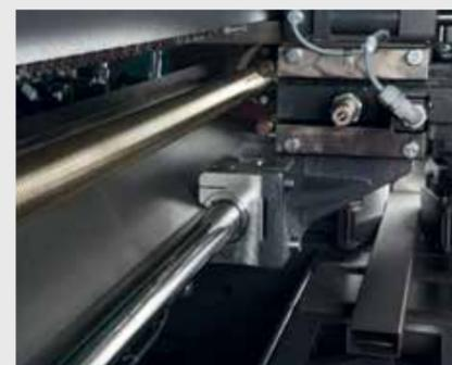
Avance automatique de la matière au moyen d'une vis à billes
