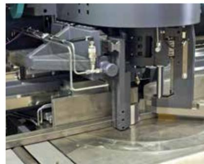
Etau vertical basculant lors des coupes biaisées pour un serrage optimal des pièces et des chutes très courtes (<15 mm)
