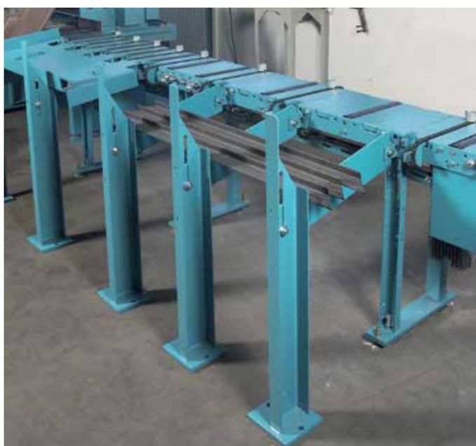
**2** Distributeur transversal à chaînes pour un triage automatique des pièces vers l'avant et l'arrière
