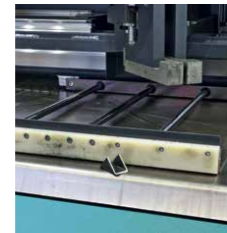
Integriertes Bürstensystem zur Entsorgung von Spänen, Anschnitten/Reststücken und Zwickeln.
