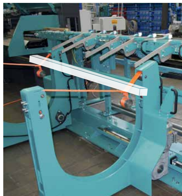
3 Automatisch absenkende Gurmulden zur Aufnahme der Abschnitte.
