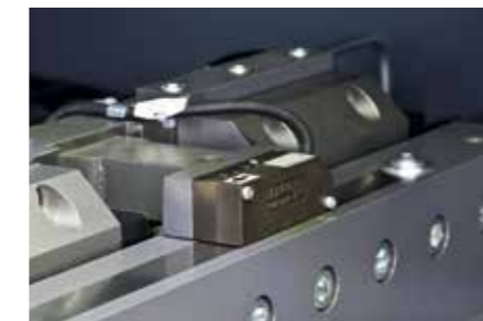
Materialbreitenvermessung mit automatischer Längskorrektur für präzise Gehrungsschnitte.
