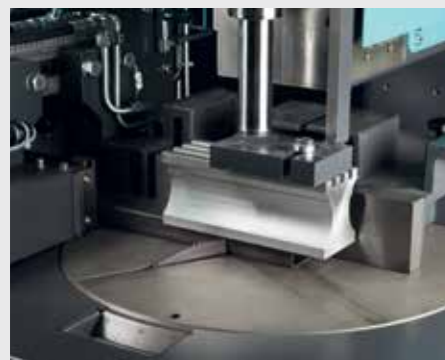
Materialspannung beidseitig vom Sägeblatt; Werkstückanschlag für beidseitige Gehrungsschnitte.
