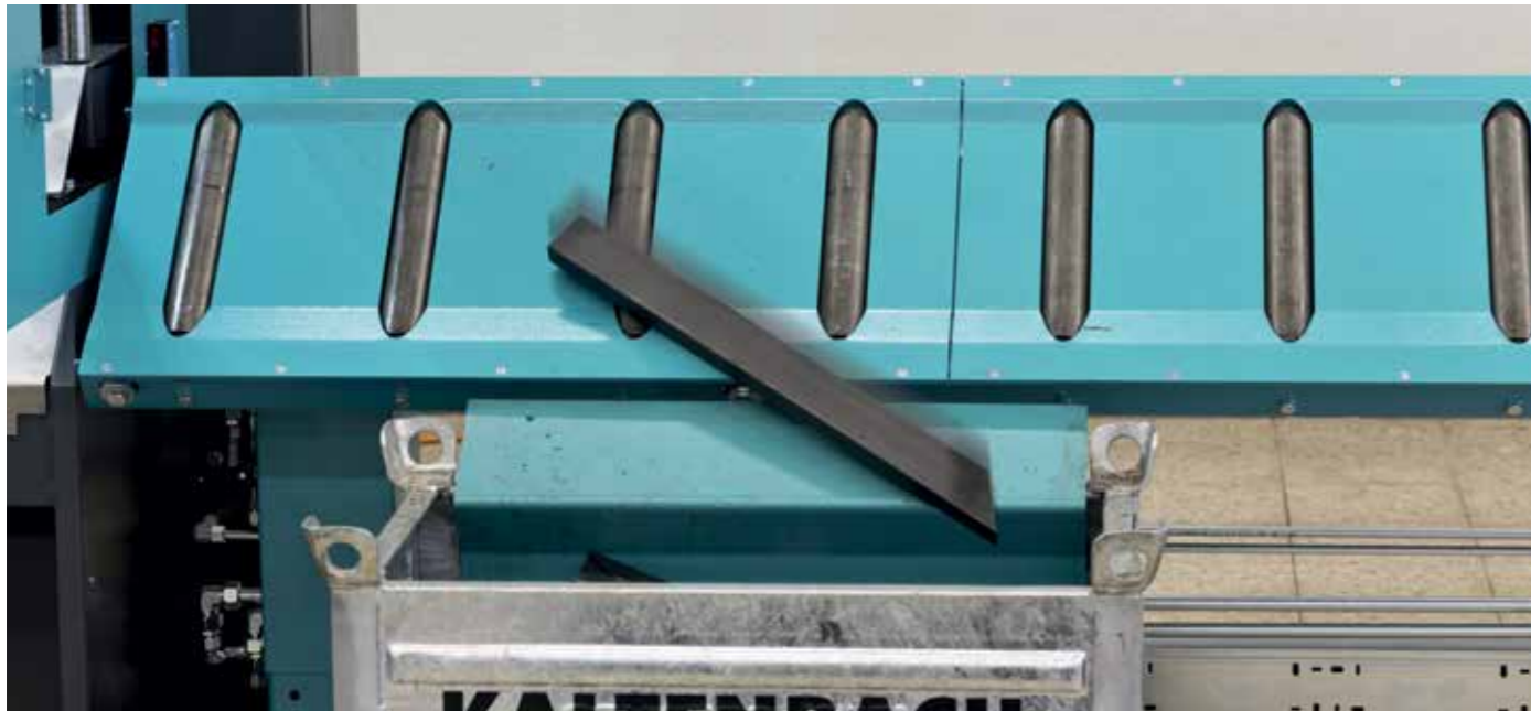
1 Kiprollenbahn Abschnitte können flexibel mittels „teach in“ auf verschiedene Positionen abgekippt werden.
