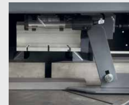
Horizontalspannstock auf der Abfahrseite zur Materialspannung während des Sägeschnittes.
