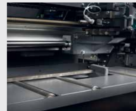
Mechanischer Anchnittanschlag zur Materialerkennung.
