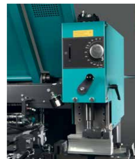
Hydraulischer Sägeblattvorschub, stufenlos einstellbar.
