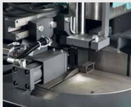
Verschiebbarer Werkstückanschlag für 90°-Schnitte und kurze Reststücklängen im Automatikbetrieb.
