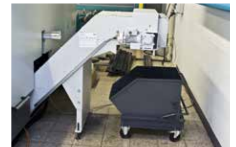
Scharnierbandförderer zur automatischen Abfuhr von Spänen, Anschnitten/Reststücken und Zwickeln.
