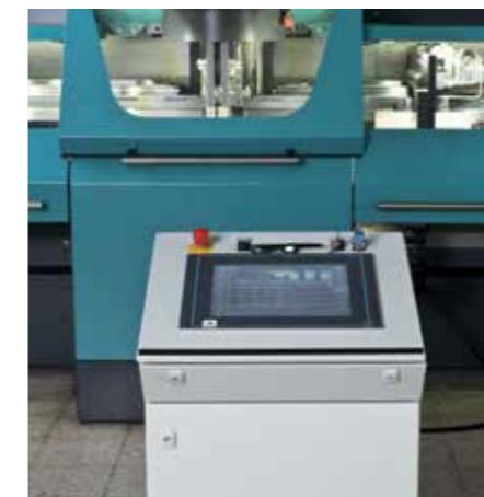
Freistehendes Bedienpult zur flexiblen Anordnung vor der Maschine.
