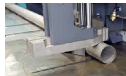
Automatische, programmgesteuerte Spanndruckreduzierung über Proportionalventile zur Verarbeitung von dünnwandigen Rohren und Sonderprofilen.
