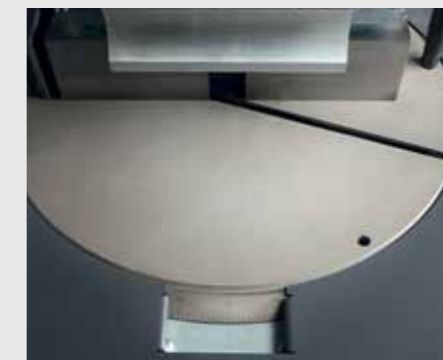
Drehtisch für Gehrungswinkel; Schwenkbereich 180°.
