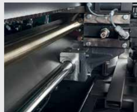
Automatischer Materialnachschub mittels Kugelumlaufspindel.
