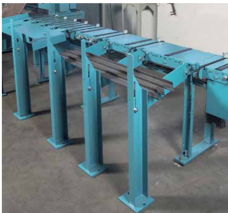
2 Abschnittquerverteiler mit quertaktenden Ketten zur automatischen Sortierung von Abschnitten nach vorne und hinten.
