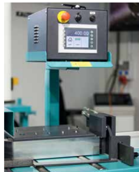
Scie circulaire universelle avec système de mesure des longueurs L 41 NC et chemin d'amenage T3
