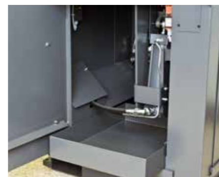
Grande porte d'accès frontale pour le changement facile de la lame de scie et l'évacuation des copeaux
