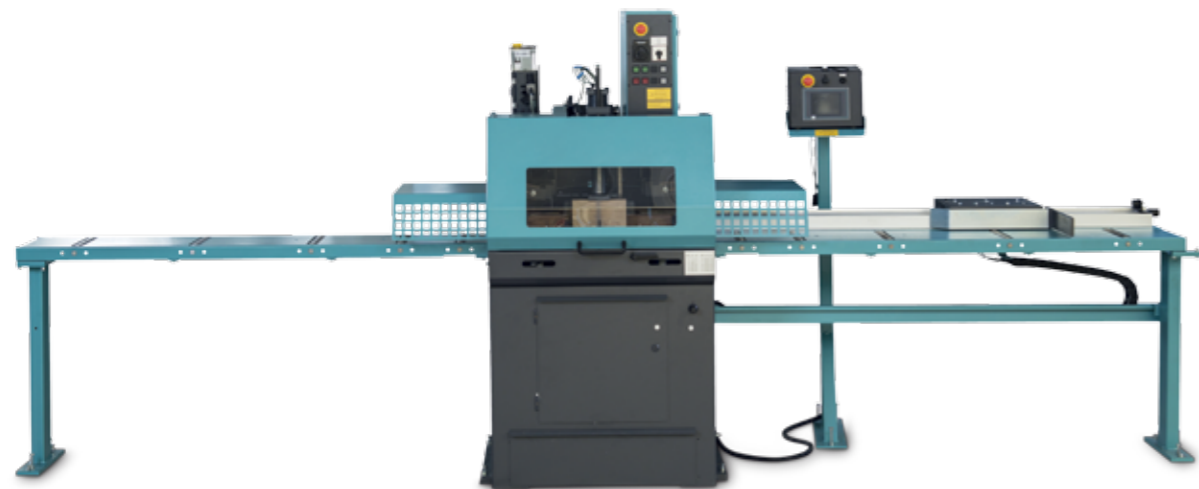
Scie circulaire universelle avec système de mesure des longueurs L 41 NC et chemin d'amenage T3
