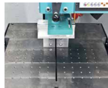
Trous de fixation dans la table de sciage destinés à réceptionner les dispositifs spécifiques du client
