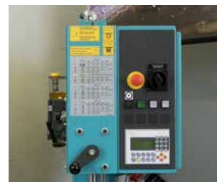
Régulation dynamique de l'avance (en option)
