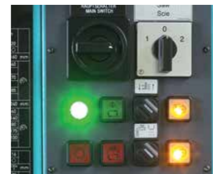
Commande simple et rapide par bouton poussoir
