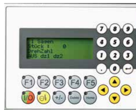
Panel de saisie et de diagnostic pour la commande et la programmation
