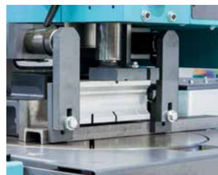
Etau horizontal à droite et/ou gauche de la lame de scie
