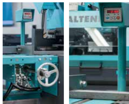
Scie circulaire universelle avec système de mesure des longueurs L 41 NC et chemin d'amenage T3
