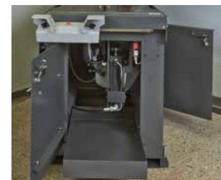
Accès aisé pour le changement de la lame et les travaux d'entretien
