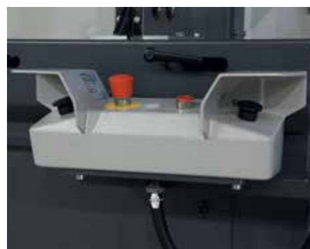
Commande de sécurité bi-manuelle au lieu d'un capot de protection
