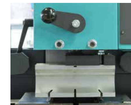
Vérin à course courte avec manivelle de pré-réglage
