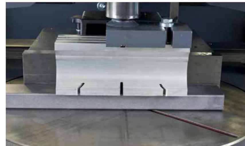
Werkstückanschlag und Materialspannung beidseitig vom Sägeblatt.
