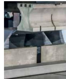
Werkstückanschlag beidseitig vom Sägeblatt.
