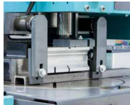
Horizontalspannstock rechts und/oder links vom Sägeblatt.
