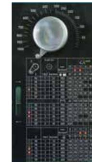
Hydraulischer Sägeblatt-Vorschub. Nach Tabelle stufenlos einstellbar.
