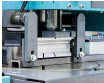
Horizontalspannstock rechts und/oder links vom Sägeblatt.
