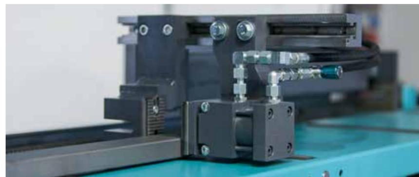
Schiebender Messwagen M 45 NC zur automatischen Materialzufuhr (KKS 400H/KKS 450 H). Alternativ Verwendung als NC-gesteuerter Längenanschlag. Der M 45 NC spannt das Material am Stabende und fährt automatisch um die programmierte Länge nach vorne.
