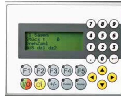
Eingabe- und Diagnosepanel zur Bedienung und Programmierung.
