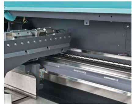
Hochpräzise Positionierung des Schnittmaterials über Kugelrollspindeln mit bürstenlosen Servomotoren. Führung des Nachschubautomaten auf robusten, wartungsarmen Linearführungen.
