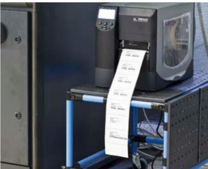
Etikettendrucker zur Kennzeichnung der Sägeabschnitte.
