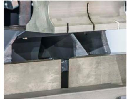
Langhub-Spannzylinder zur Minimierung des Rüstaufwands.
