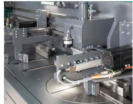
Automatische Abschnittsortierung mittels Greifer.
