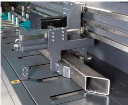
Hochpräzise Positionierung des Schnittmaterials über Nachschubgreifer, geführt über robuste Linearführungen.
