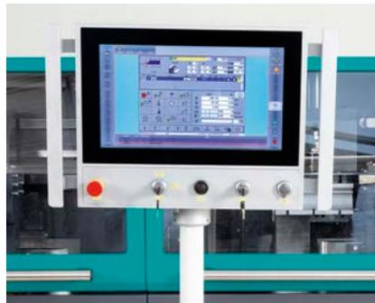
Schwenkbares Bedienpanel mit Touch Screen.
