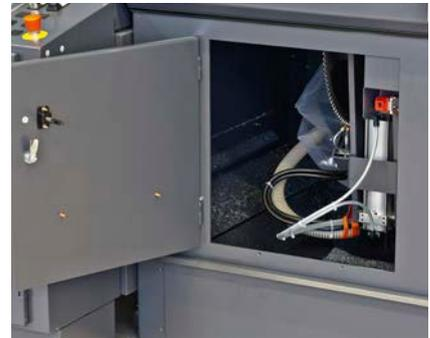
Große Fronttür für schnellen Sägeblattwechsel und einfache Wartung.
