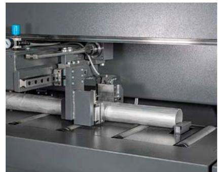
Mechanischer An schnittanschlag.
