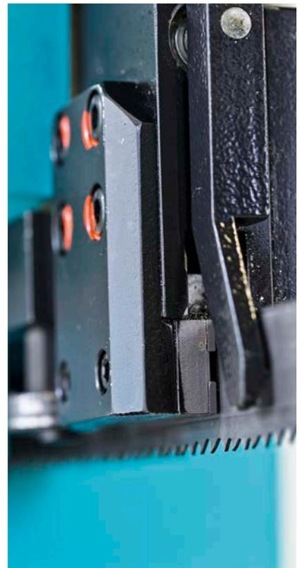
Hartmetallbestückte Sägebandführungen für höchste Schnittgenauigkeit.
