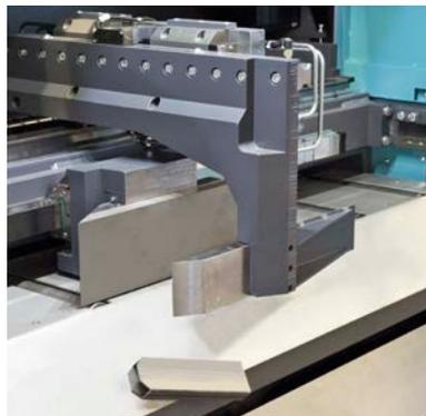
Automatische Abschnittsortiereinrichtung KKS 463 NA.
