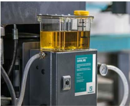
Minimalschmierung für nahezu trockene
