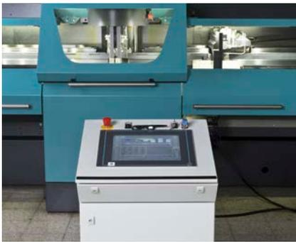
Freistehendes Bedienpult zur flexiblen Anordnung vor der Maschine.
