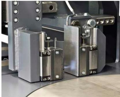
Hochpräzise Materialpositionierung mittels Nachschubgreifer mit Kugelrollspindel.
