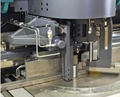
Mitschwenkender Vertikalspannstock für optimale Materialspannung und kürzeste Reststücklängen (>15 mm).
