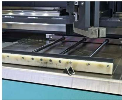
Integriertes Bürstensystem zur Entsorgung von Spänen, Anschnitten/Reststücken und Zwickeln.
