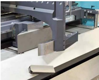
Abschnittgreifer zur abfahrseitigen Materialspannung während des Sägeschnittes sowie zur Sortierung von Anschnitten/Reststücken und Gutteilen auf vorwählbare Positionen.
