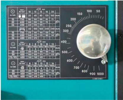
Hydraulischer Sägeblattvorschub, nach Tabelle stufenlos einstellbar.
