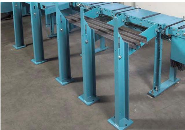
Abschnittquerverteiler mit quertaktenden Ketten zur automatischen Sortierung von Abschnitten nach vorne und hinten (nur KKS 463 NA).
