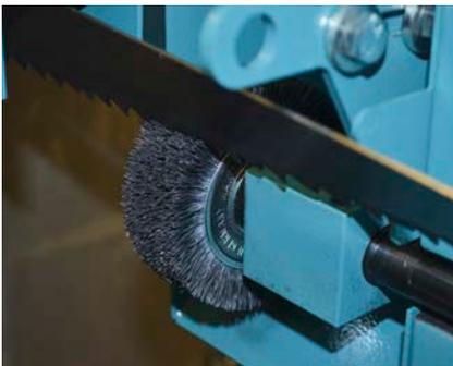
Separat angetriebene Spänebürste.
