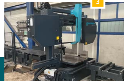
Bewährter hydraulischer Sägevorschub
