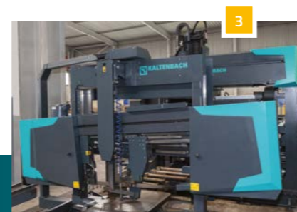
3 Leistungsstarke, neu entwickelte Sägemaschine mit 54 mm Sägeband
