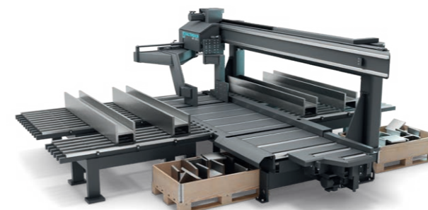
Autosorter: Automatischer Abtransport von Gutteilen auf bis zu sechs Abschiebepositionen
