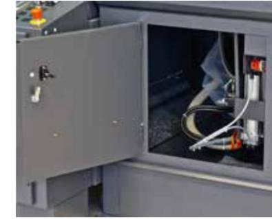
Große Fronttür für schnellen Sägeblattwechsel und einfache Wartung.
