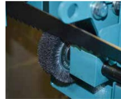
Separat angetriebene Spänebürste.
