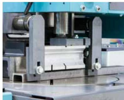
Horizontalspannstock rechts und/oder links vom Sägeblatt für optimale Materialspannung.
