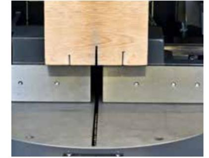
Vertikales Hartholz-Druckstück zum Schutz der Materialoberfläche.
