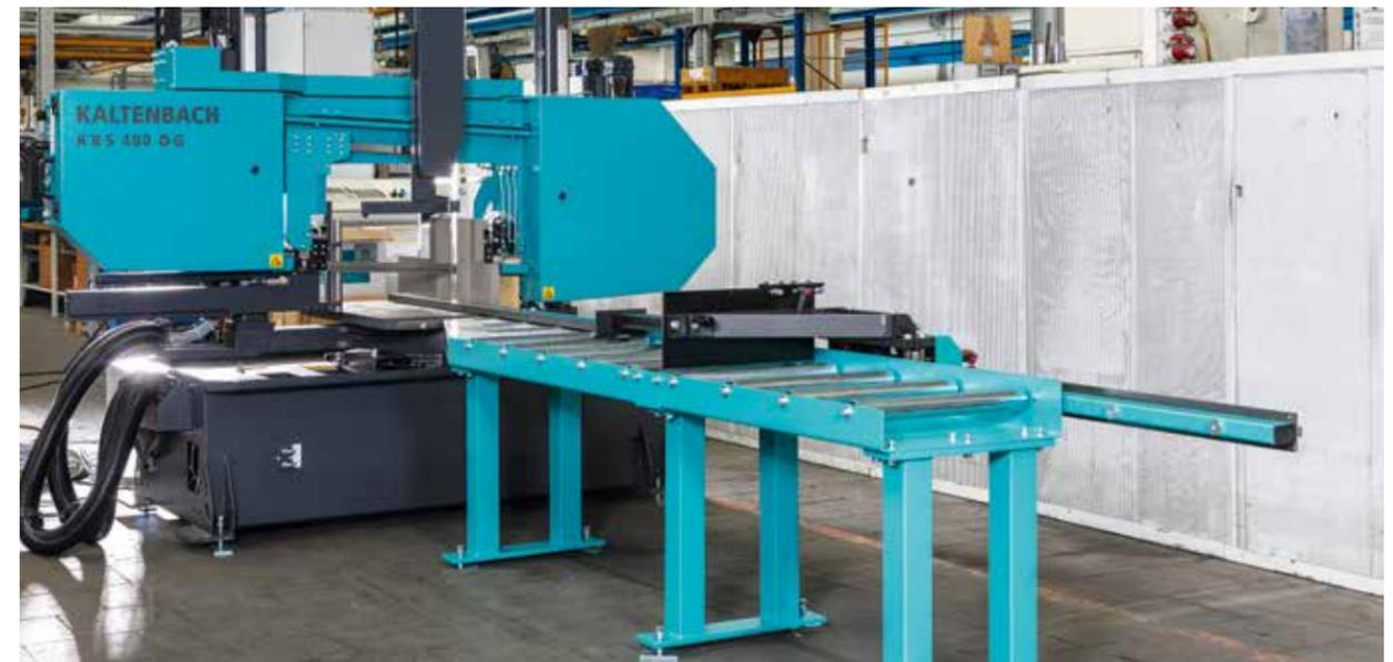
Bandsägemaschine KBS mit manuellem Längenanschlag.
