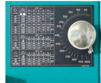
Hydraulischer Sägeblatt-Vorschub, nach Tabelle stufenlos einstellbar.
