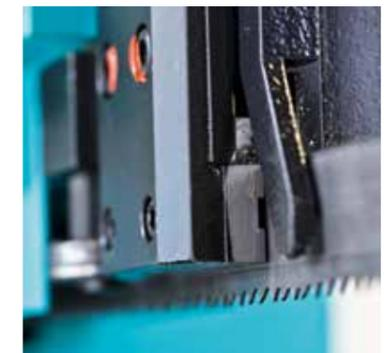
Hartmetallbestückte Sägebandführung der Baureihe KBS.
