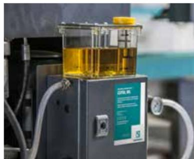
Minimalschmierung optional zusätzlich zur Wasserkühlung für nahezu trockene Schnittflächen.
