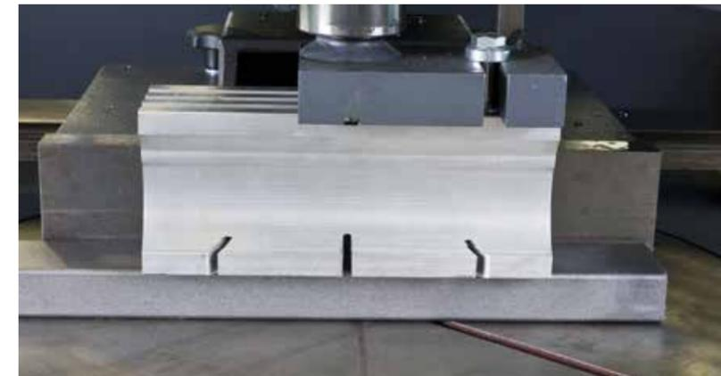
Werkstückanschlag und Materialspannung beidseitig vom Sägeblatt.
