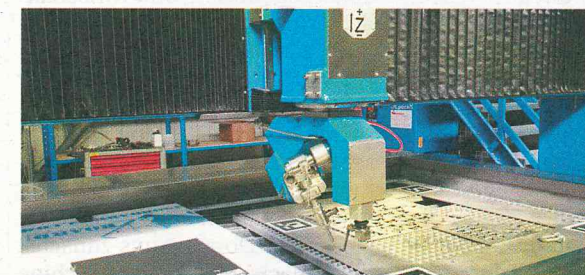
Der Mini-Schneidkopf punktet dann, wenn in Mehrachsmaschinen wenig Platz zur Verfügung steht, so KMT.
